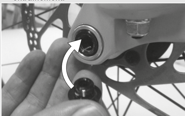
Illustration 28 : Enfoncer le levier d'attache rapide dans l'axe
