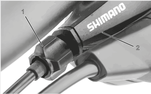
Illustration 90 : Douille de réglage (1) du changement de vitesse à un câble actionné par câble avec boîtier de manette de vitesse (2), exemple
