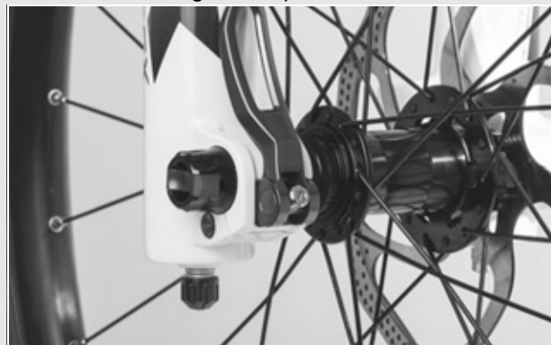
Illustration 36 : Position parfaite du levier de serrage
