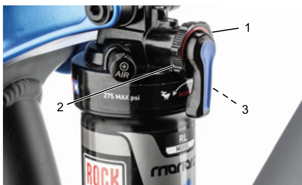
Illustration 83 : Régler la dureté de l'amortisseur de détente (1) de l'amortisseur arrière
