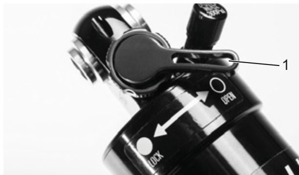
Illustration 81 : Dispositif de réglage de la compression Suntour ouvert (1)
