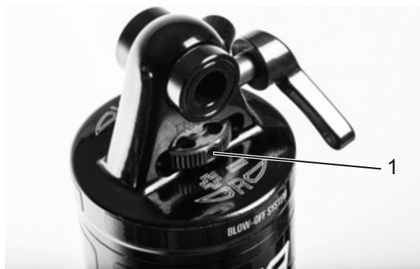
Illustration 61 : Molette de réglage de la détente Suntour (1) sur l'amortisseur arrière
