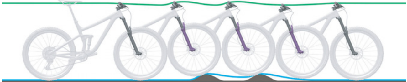
Figura 72: Descompresión demasiado lenta de la horquilla de suspensión
