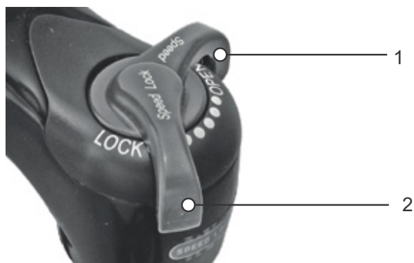
Figura 77: Amortiguador de niveles de presión Suntour en posición abierta (1) y cerrada (2)
