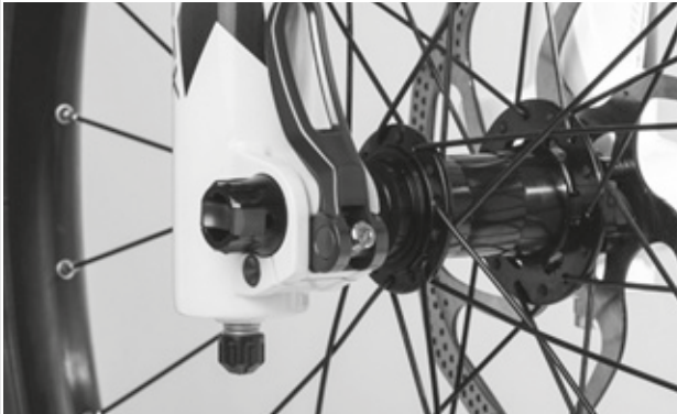
Figura 65: Ajuste de la fuerza de tensado del cierre rápido
