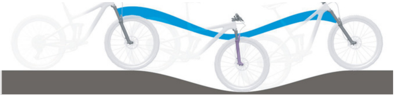
Figura 74: Suspensión de la horquilla de suspensión demasiado blanda en montaña
