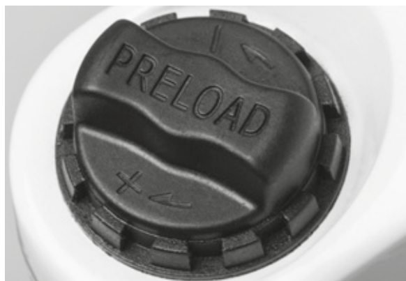
Figura 40: Rueda de ajuste SAG en la corona de la horquilla de suspensión
