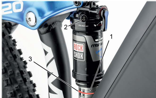
Figura 19: Ajustar la dureza en el elemento amortiguador de muelle
