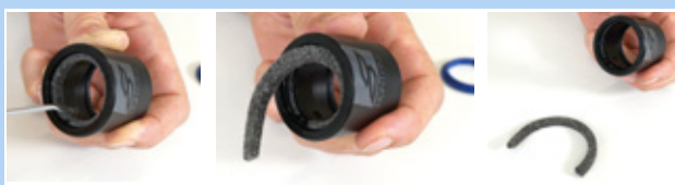
Figura 223: Retirada del anillo de fieltro
