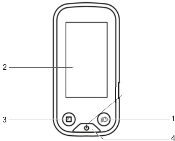
Figura 39: Detalles del ordenador de a bordo SC-E6100
