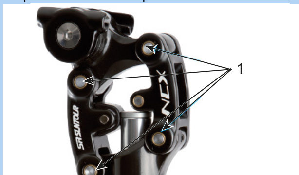
Figura 176: Puntos de lubricación de la tija de sillín de muelle SR Suntour
