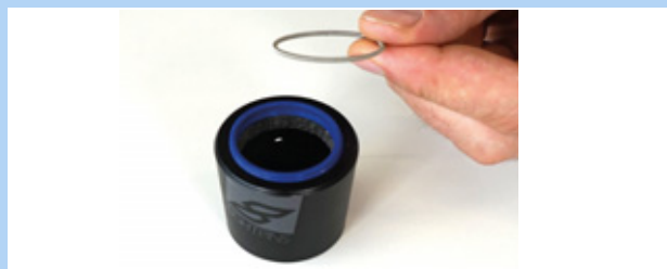
Figura 186: Arandela elástica retirada
