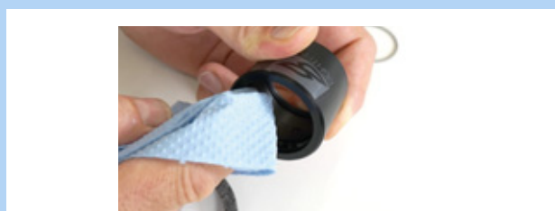
Figura 189: Limpieza del manguito exterior
