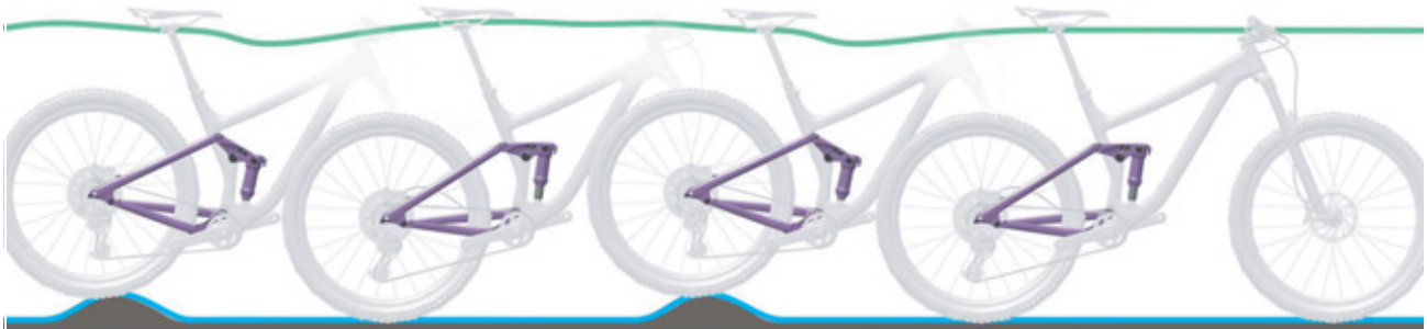
Figura 115: Condición óptima de marcha del amortiguador de la horquilla trasera
