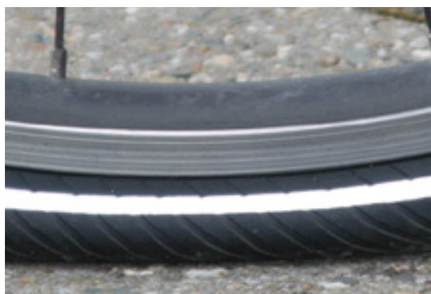
Figura 89: Presión de inflado demasiado baja
