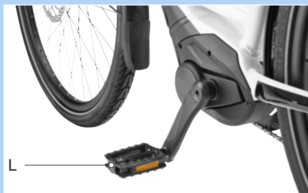
Figura 66: Pedal L en el brazo de manivela izquierdo
