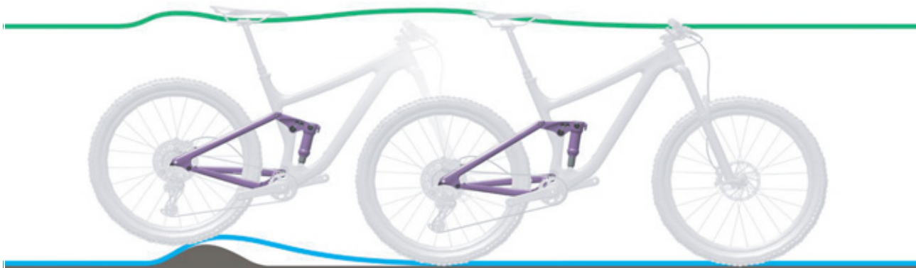
Figura 269: Amortiguación del amortiguador de la horquilla trasera demasiado dura en caso de irregularidades
