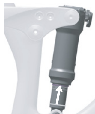
Figura 113: Desplazamiento de la junta tórica en el amortiguador de la horquilla trasera
