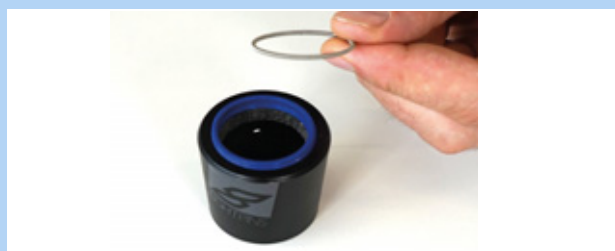
Figura 221: Arandela elástica retirada
