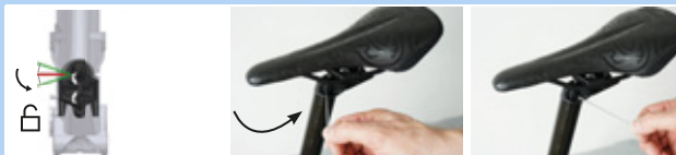
Figura 177: Colocar el accionamiento del ajuste de altura en la "Posición abierta"
