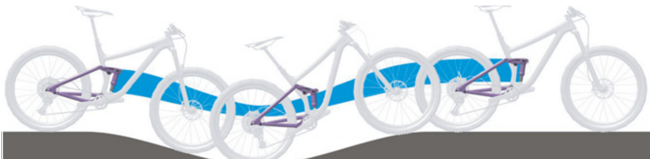
Figura 259: Suspensión del amortiguador de la horquilla trasera demasiado blanda en montaña
