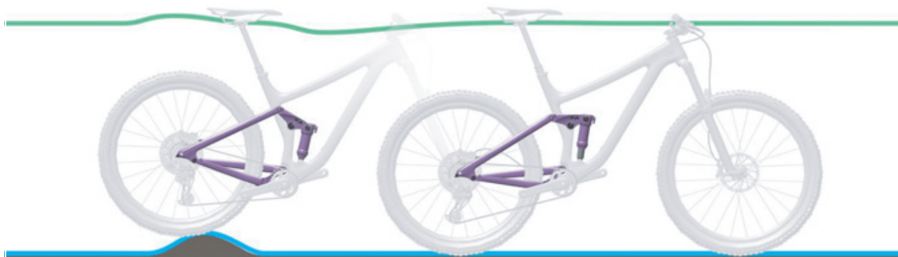
Figura 117: Condición óptima de marcha del amortiguador de la horquilla trasera en caso de irregularidades
