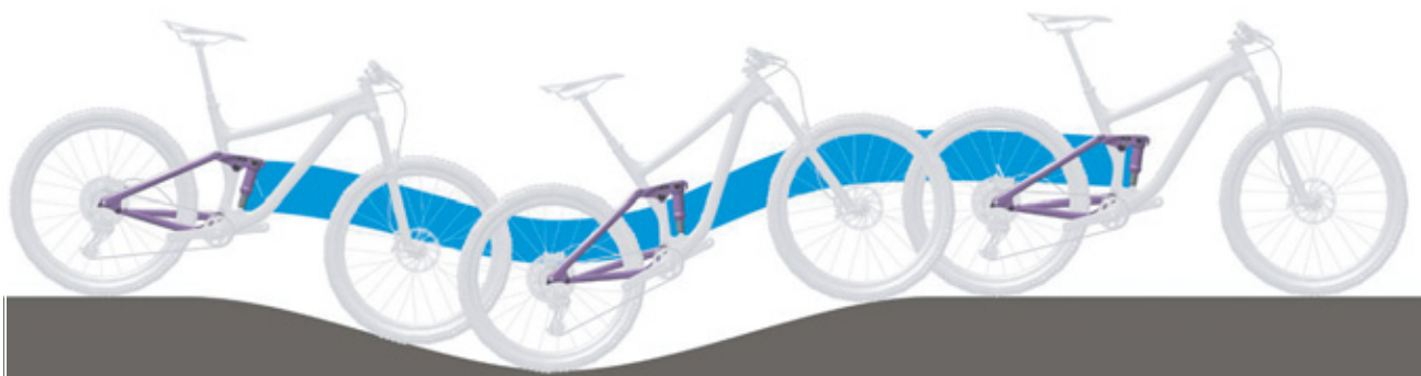
Figura 16: Condición óptima de marcha del amortiguador de la horquilla trasera sobre un terreno accidentado
