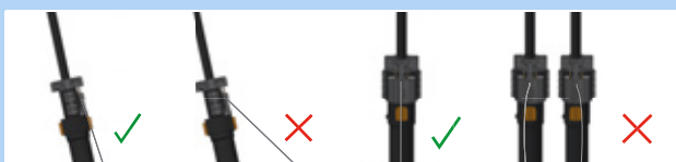
Figura 204: Cable Bowden correcto e incorrecto
