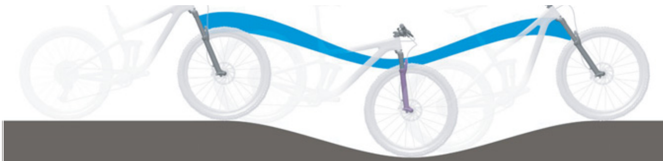
Figura 243: Suspensión de la horquilla de suspensión demasiado blanda en montaña
