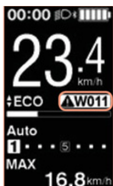
Figura 68: Ejemplo de indicación de advertencia W0110
