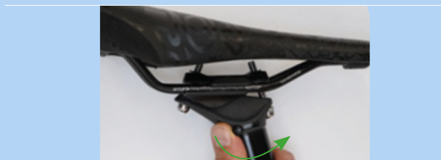
Figura 228: Apertura del ajuste de altura
