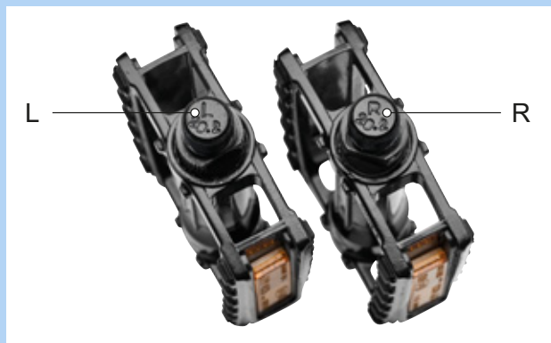
Figura 65: Ejemplo de identificación de los pedales
