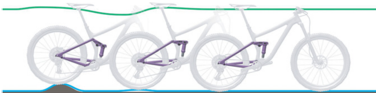
Figura 255: Descompresión demasiado rápida del amortiguador de la horquilla trasera
