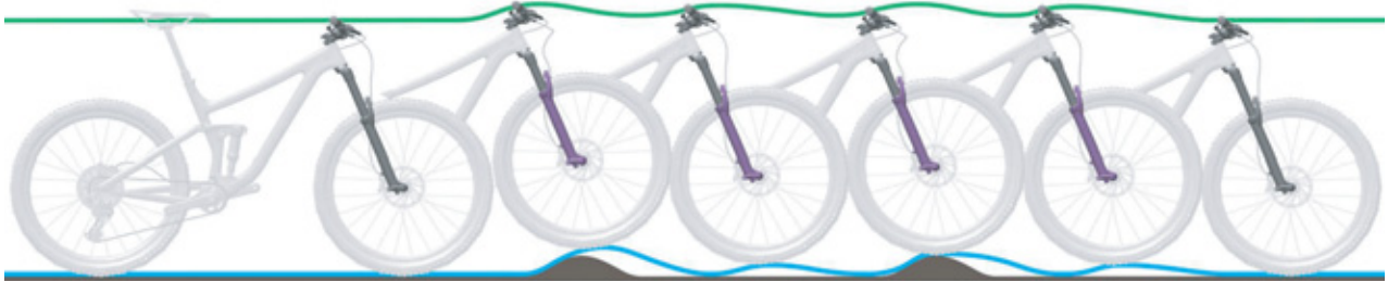
Figura 247: Descompresión demasiado rápida de la horquilla de suspensión
