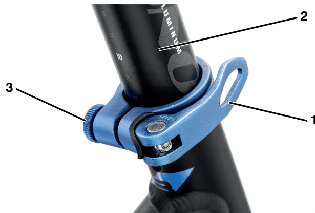
Abbildung 15: Schnellspanner der Sattelstütze in der Endposition
