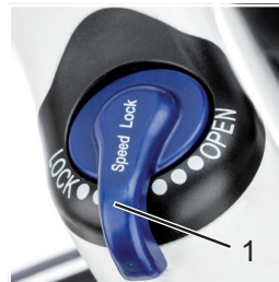
Abbildung 24: Gabelsperre am Federgabelkopf mit Sperrhebel (1), Beispiel
