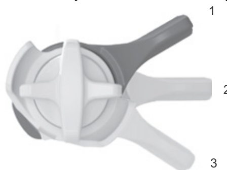
Obr. 77: Nastavovací šroub komprese FOX na tlumiči zadního odpružení s polohami OTEVŘENÁ (1), STŘEDNÍ (2) a TVRDÁ (3)
