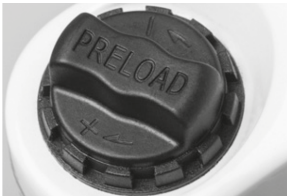
Obr. 57: Nastavovací kolečko zanoření na korunce odpružené vidlice
