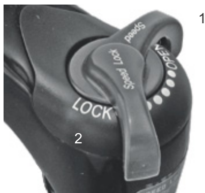
Obr. 79: Nastavovací šroub komprese Suntour s polohami OTEVŘENÁ (1) a UZAVŘENÁ (2)
