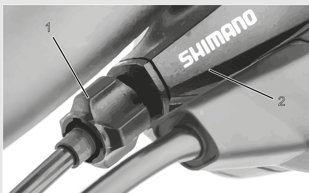
Obr. 89: Seřizovací pouzdro (1) řazení převodů ovládané jedním lankem s řadicí páčkou (2) - příklad
