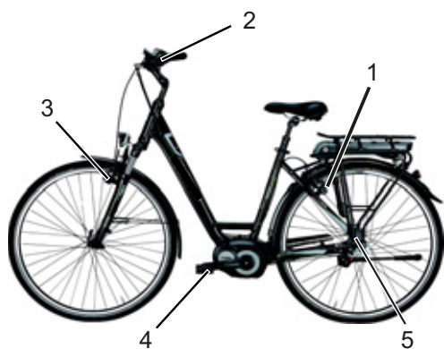
Obr. 12: Příklad brzdového systému Pedelec s brzdou zpětným sešlápnutím
