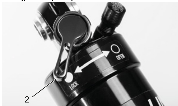
Obr. 81: Nastavovací šroub komprese Suntour zavřený (2)
