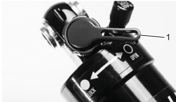
Obr. 80: Nastavovací šroub komprese Suntour otevřený (1)
