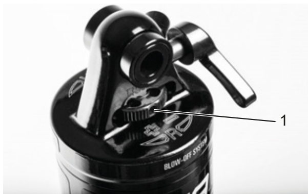
Obr. 60: Nastavovací kolečko odskoku Suntour (1) na tlumiči zadního odpružení
