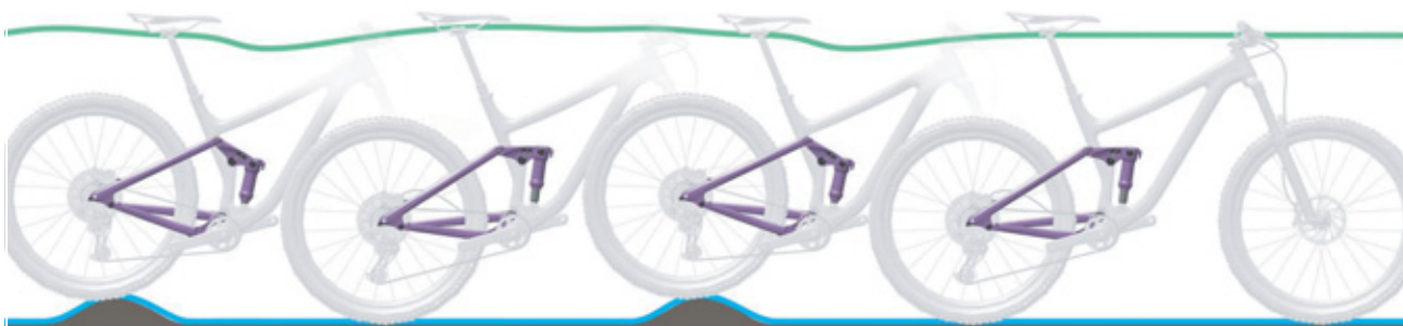
Obr. 15: Optimální chování tlumiče zadního odpružení při jízdě
