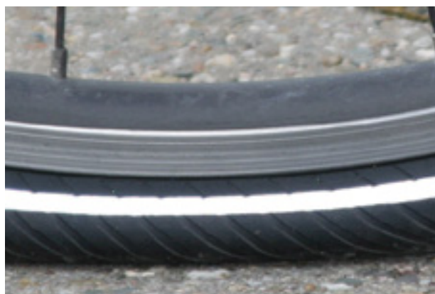
Obr. 89: Příliš nízký tlak
