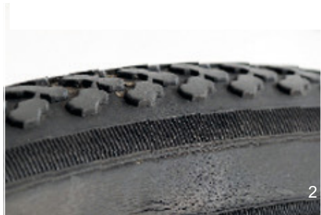
Obr. 165: Příklady únavových trhlin (1) a trhlin vzniklých stárnutím (2)
