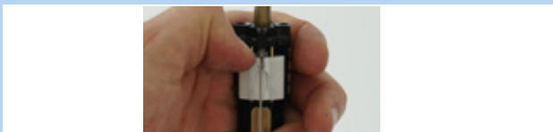
Obr. 203: Posunutí bílého ovládacího šoupátka dolů
