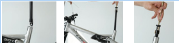
Obr. 205: Upevnění krytu ventilku kazety
