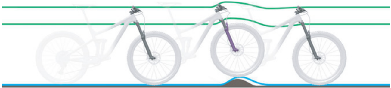
Obr. 245: Příliš tvrdé tlumení odpružené vidlice u nerovností
