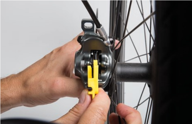
Obr. 166: Kontrola brzdového obložení v namontovaném stavu pomocí přepravní pojistky
