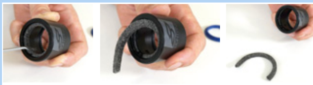
Obr. 223: Odstranění plstěného kroužku
