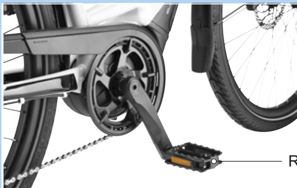
Obr. 67: Pedál R pravého ramena kliky
