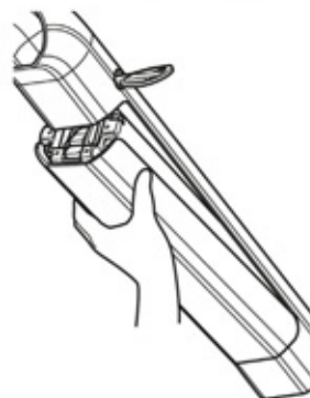
Obr. 138: Akumulátor je odjištěný
