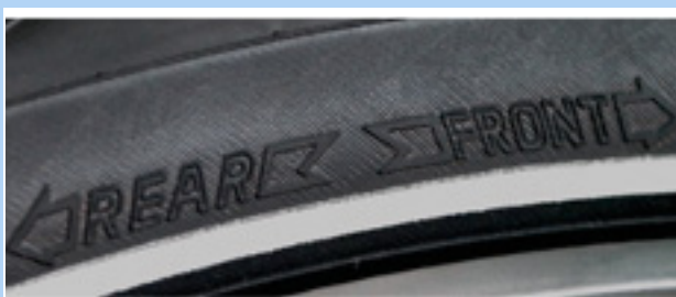
Obr. 50: Šipka na pláštích MTB
