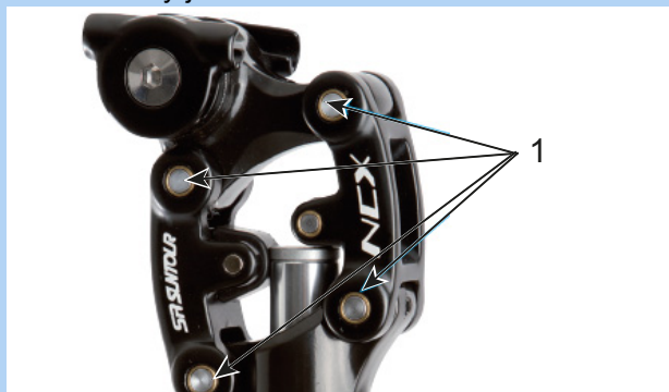
Obr. 176: Mazací body odpružené sedlovky Suntour SR
