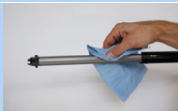
Obr. 230: Očištění podélné vodicí drážky
