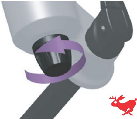
Obr. 250: Otočení šroubu odskoku směrem k zajíci
