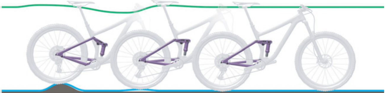
Obr. 263: Příliš rychlé roztahování tlumiče zadního odpružení
