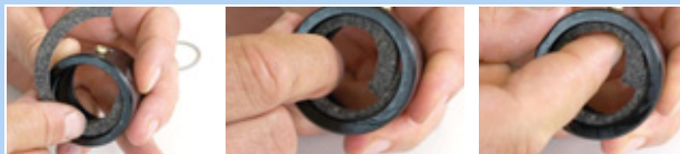
Obr. 225: Vložení plstěného kroužku
