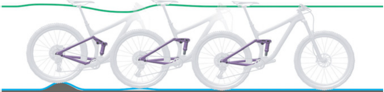
Obr. 255: Příliš rychlé roztahování tlumiče zadního odpružení
