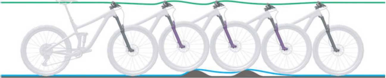
Obr. 249: Příliš pomalé roztahování odpružené vidlice
