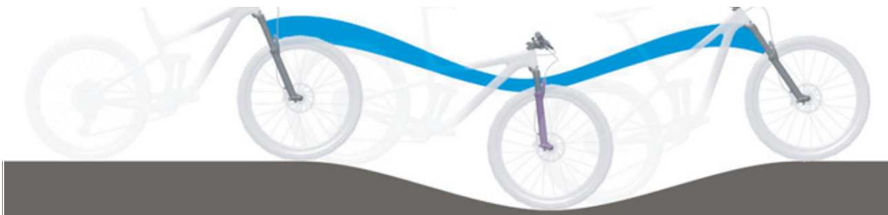
Obr. 243: Příliš měkké odpružení odpružené vidlice v horách
