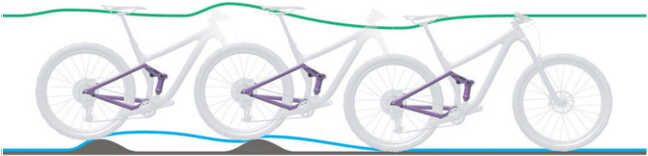
Obr. 265: Příliš pomalé roztahování tlumiče zadního odpružení
