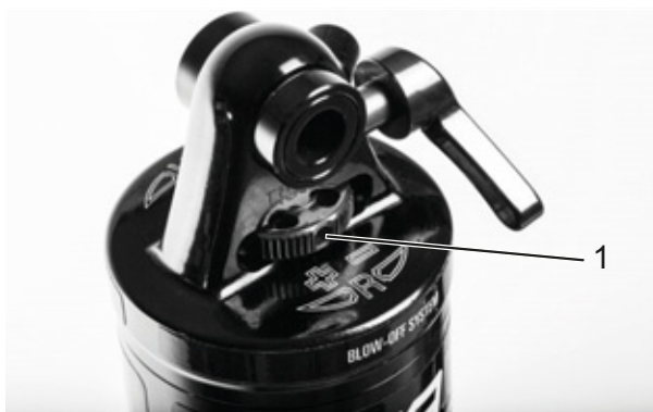
Figur 42: Hjul (1) for Suntour-træktrinsindstillingsanordning på bagdæmperen
