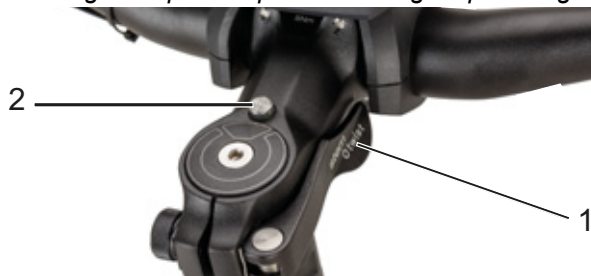
Figur 58: Frempind, udførelse II med greb på frempindens hurtigbespænding (1) og frigørelsesknapp (2)
