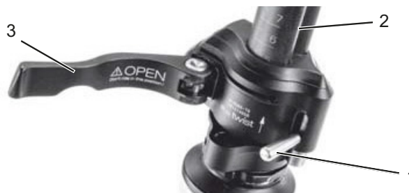
Figur 57: Åbnet greb på hurtigbespændingen (3) på frempinden (2), udførelse I, med låsegreb på frempinden (1)
