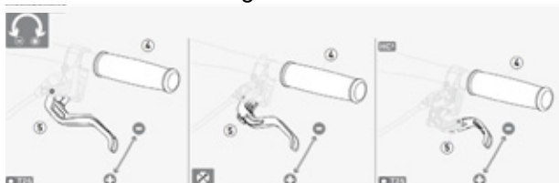
Figur 36: Indstilling af grebsbredden på Magura skivebremse bremsegreb
