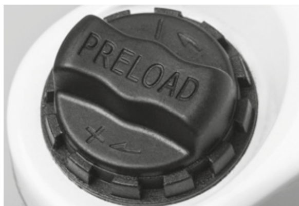
Figur 38: Indstillingshjulet til den negative fjedervandring på fjedergafflens krone
