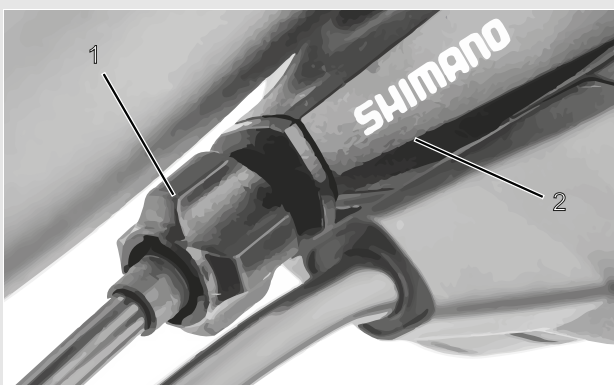
Figur 66: Slutmuffe (1) på gearskiftet med ét kabel og gearvælgerhus (2), eksempel
