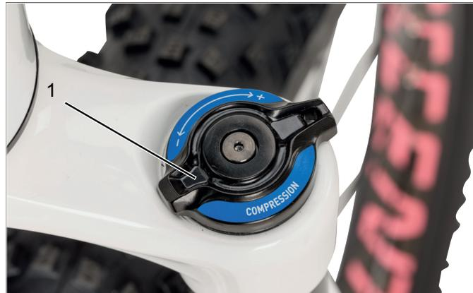
Illustration 31 : Amortisseur de compression avec levier de blocage (1), exemple
