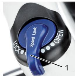
► Pour bloquer la *suspension de la roue avant*, le *levier de blocage* doit être poussé en position LOCK.
