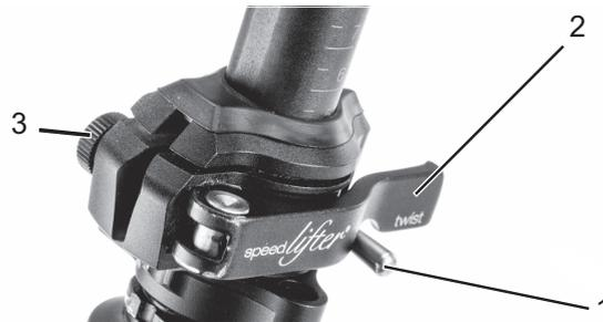
Illustration 23 : Levier de serrage fermé (2) avec écrou moleté (3) et levier de blocage (1) sur la potence
