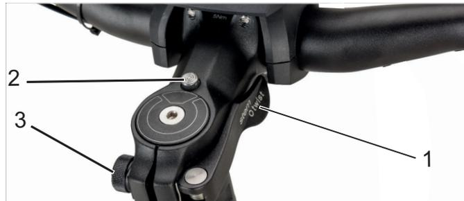
Illustration 24 : Potence, modèle II avec levier de serrage (1), bouton de déblocage (2) et écrou moleté (3)
