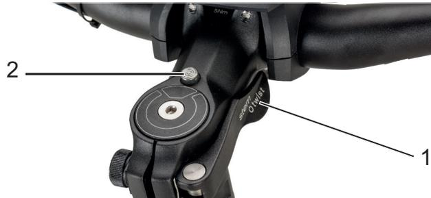
Illustration 45 : Potence, modèle II avec levier de serrage de l'attache rapide de la potence (1) et bouton de déblocage (2)
