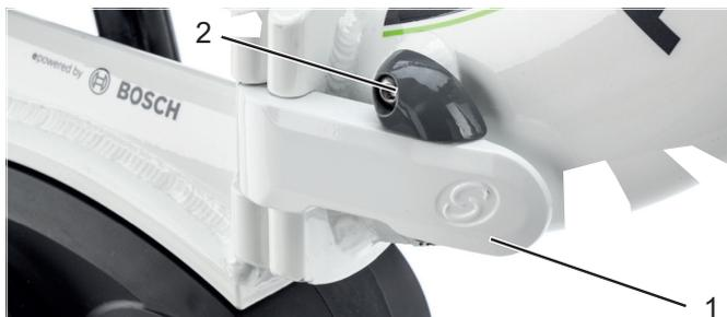
**Illustration 47 :** Cadre, avec levier de serrage du cadre fermé (1) et levier de blocage du cadre fermé (2)
