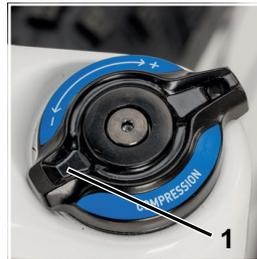
► Pour bloquer la suspension, tourner le levier de blocage dans la direction Plus.
