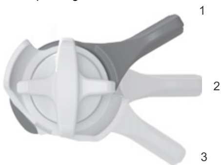
Figura 85: Regolatore della compressione FOX sull'ammortizzatore del carro posteriore con le posizioni APERTO (1), MEDIO (2) e RIGIDO (3)
