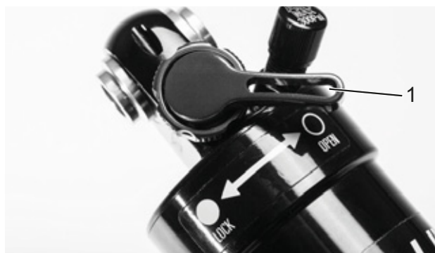
Figura 88: Regolatore della compressione Suntour aperto (1)
