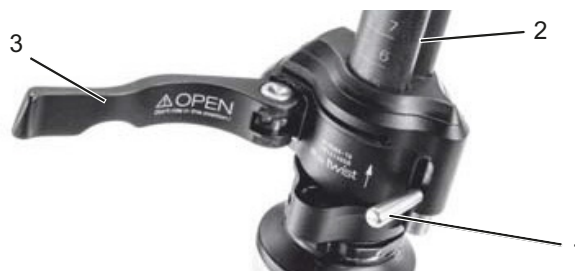
Figura 71: Leva di serraggio (3) del bloccaggio rapido dell'attacco manubrio aperta sull'attacco manubrio (2), versione I, con leva di sicurezza (1) sull'attacco manubrio
