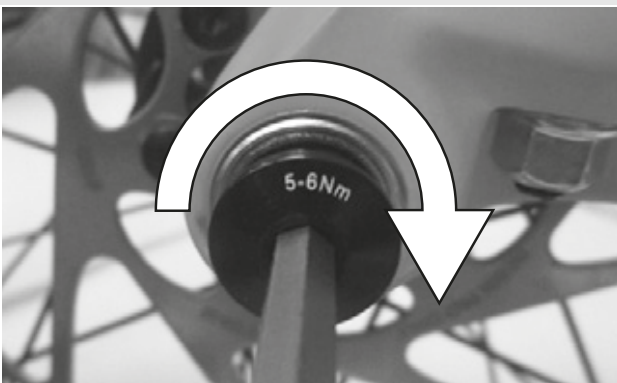
Figura 31: Serraggio della vite di sicurezza
