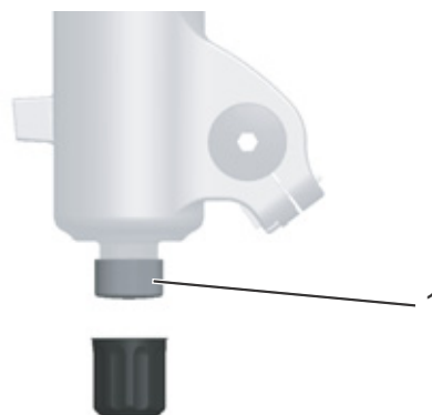
Figura 63: Regolatore del rebound FOX (1) sulla forcella
