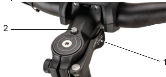
Figura 72: Attacco manubrio, versione II con leva di serraggio (1) del bloccaggio rapido dell'attacco manubrio e bottone di sbloccaggio (2)
