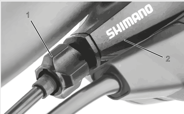
Figura 97: Boccola di regolazione (1) del cambio azionato da cavo singolo con scatola della leva del cambio (2), esempio
