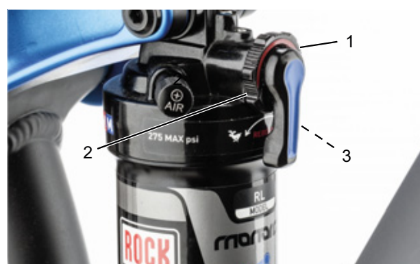
Figura 90: Regolazione della rigidità dell'ammortizzatore a stadi di trazione con la manopola di regolazione (1) dell'ammortizzatore del carro posteriore
