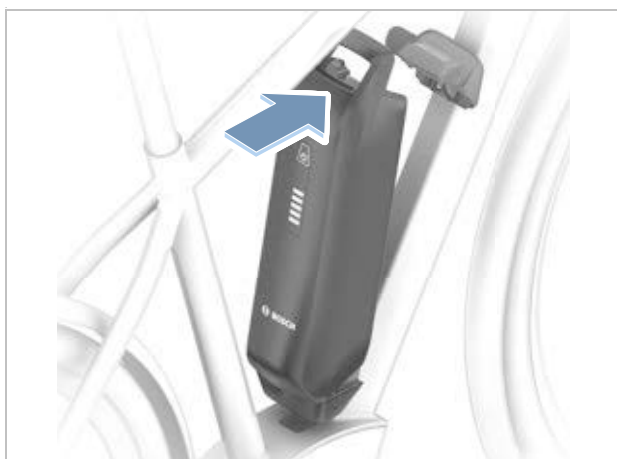
Afbeelding 110: PowerPack accu omhoog klappen
