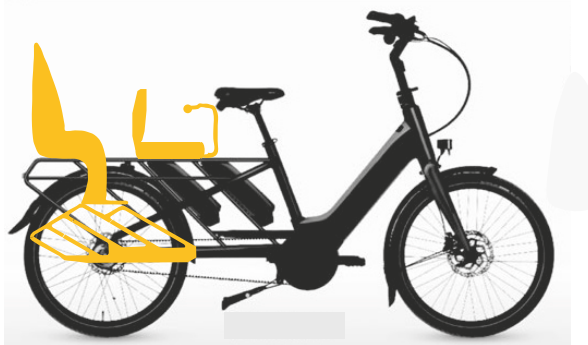
Afbeelding 107: Een kinderzitje achter en een zitkussen met voetsteunen (sideblades) voor, geschikt voor een jong kind (1-6 jaar, 9-22 kg) en een ouder kind (6-10 jaar, 18-38 kg)
