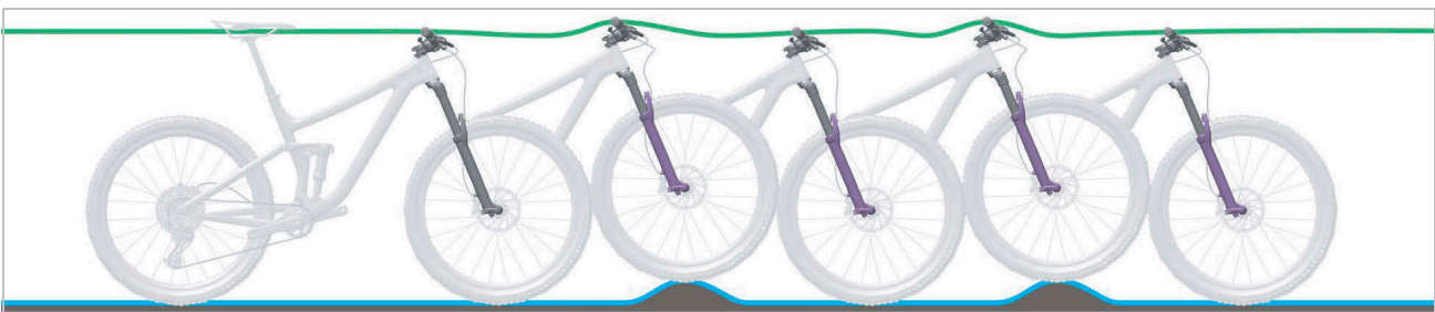
Afbeelding 13: Optimaal rijgedrag van de verende voorvork
