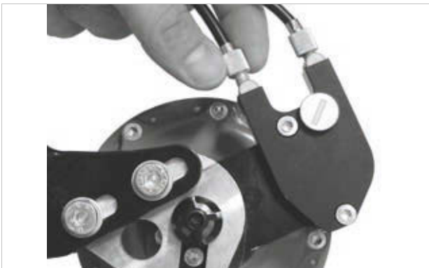
Afbeelding 155: Bij ROHLOFF naafversies met externe schakelaansturing zit de kabelafsteller op de kabelbox aan de linkerkzijde
