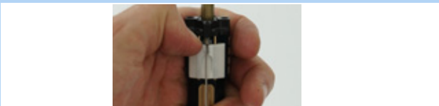
Afbeelding 195: Witte schuif omlaag schuiven
