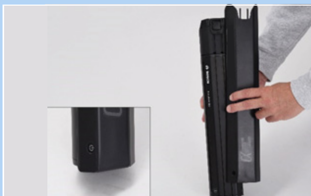
Afbeelding 63: Accuafdekking op de accu schuiven
