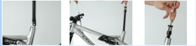
Afbeelding 197: Ventieldop van de patroon aanbrengen
