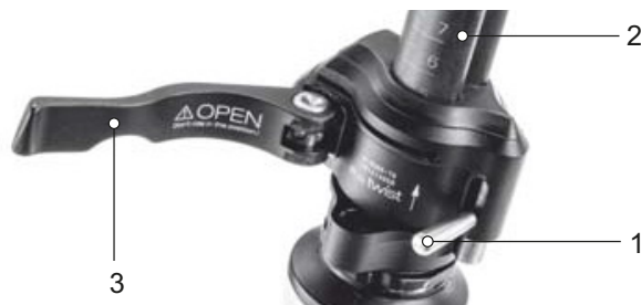
Afbeelding 146: Geopende spanhendel van de snelspanner (3) op de voorbouw (2), uitvoering I, met vergrendelhendel op de voorbouw (1)
