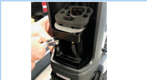
Afbeelding 52: 4 mm zeskantschroeven verwijderen
