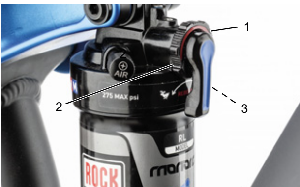
90. ábra: A húzófokozatos lengéscsillapító keménységének beállítása a hátsó lengéscsillapító beállító kerekével (1)
