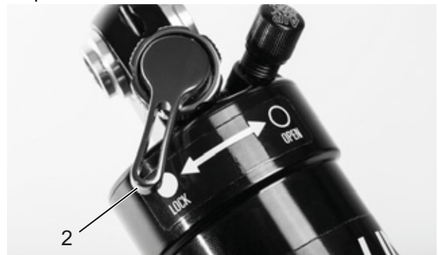
89. ábra: Suntour nyomásfokozat-beállító zárva (2)
