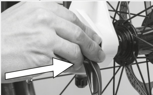
41. ábra: A gyorsár betolása
