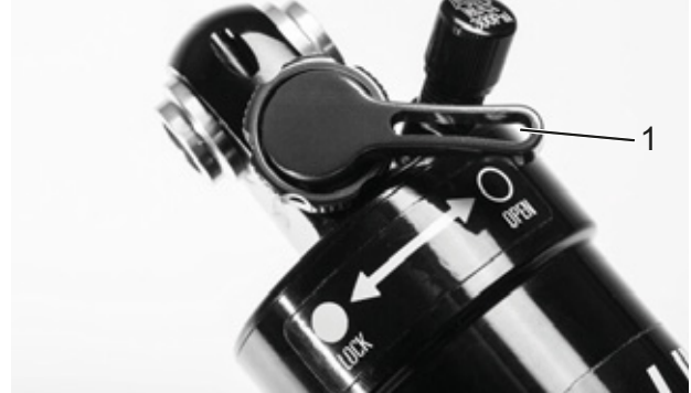
88. ábra: Suntour nyomásfokozat-beállító nyitva (1)
