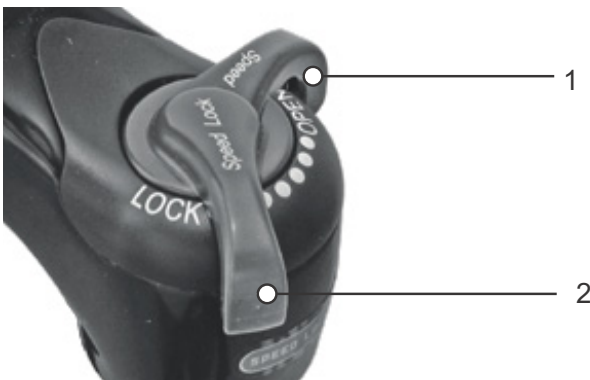
87. ábra: Suntour nyomásfokozat-beállító OPEN (1) és LOCK (2) pozíciókkal
