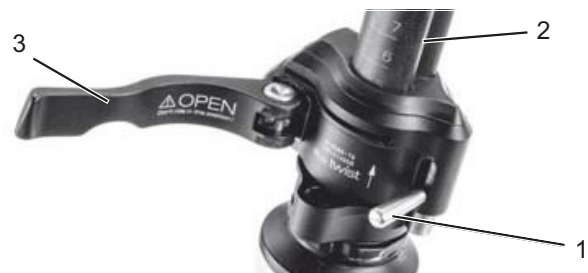
71. ábra: A kormányzár-gyorszár (3) nyitott gyorskioldója a kormányzáron (2), I kivitel, a kormányzáron (1) lévő rögzítőkarral
