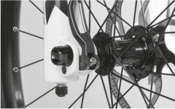
38. ábra: A gyorskioldó kar tökéletes helyzete
