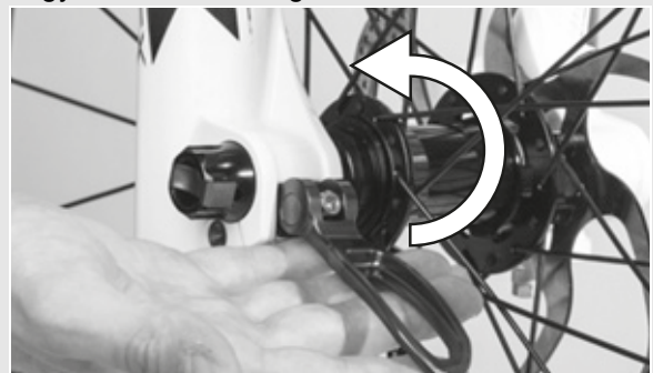
37. ábra: A kar rögzítése
