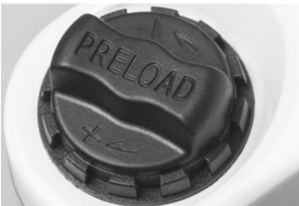
61. ábra: A negatív rugóút beállító kereke a teleszkópos villa koronáján
