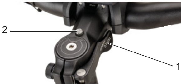
72. ábra: II kivitelű kormányoszár a kormányoszár-gyorszár (1) gyorskioldójával és reteszelésoldó gombbal (2)
