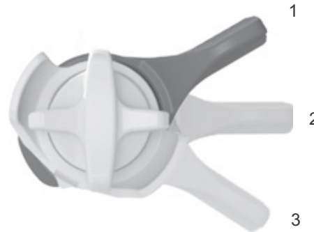
85. ábra: FOX nyomásfokozat-beállító a hátsó lengéscsillapítón NYITOTT (1), KÖZÉPES (2) és KEMÉNY (3) helyzettel
