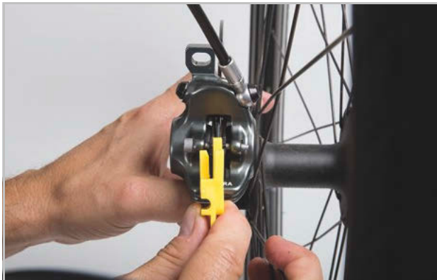
214. ábra: Fékbetét ellenőrzése beépített állapotban a szállítási rögzítés segítségével
