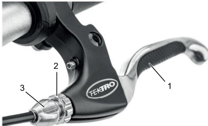
**Figura 66:** Leva del freno (1), controdado (2) e vite di regolazione (3) del freno a pattino azionato da cavo
