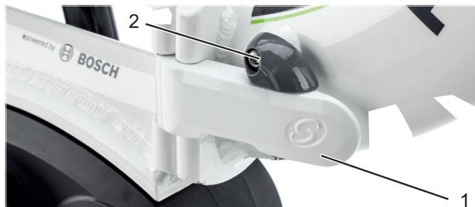
**Figura 47:** Telaio con leva di serraggio (1) chiusa e leva di sicurezza (2) chiusa
