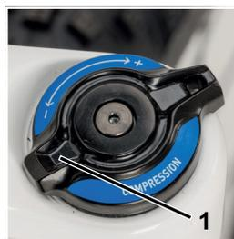
► Per bloccare la sospensione, ruotare la leva di bloccaggio in verso più.
