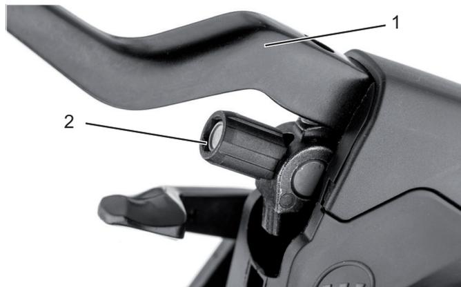
Figura 65: Leva del freno (1) del freno a pattino ad azionamento idraulico con vite di regolazione (2)
