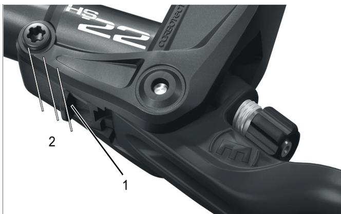
Figura 32: Leva del freno con cursore (1) e le sue tre posizioni (2)
