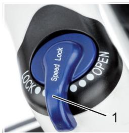
► Per bloccare la *sospensione della ruota anteriore*, spingere la *leva di bloccaggio* in posizione LOCK.
