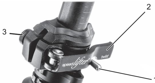
**Figura 23:** Leva di serraggio (2) chiusa con dado zigrinato (3) e leva di sicurezza (1) sull'attacco manubrio
