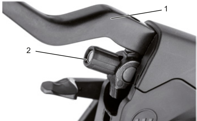
73. ábra: A hidraulikus működésű felnifék fékkarja (1) beállítócsavarral (2)
