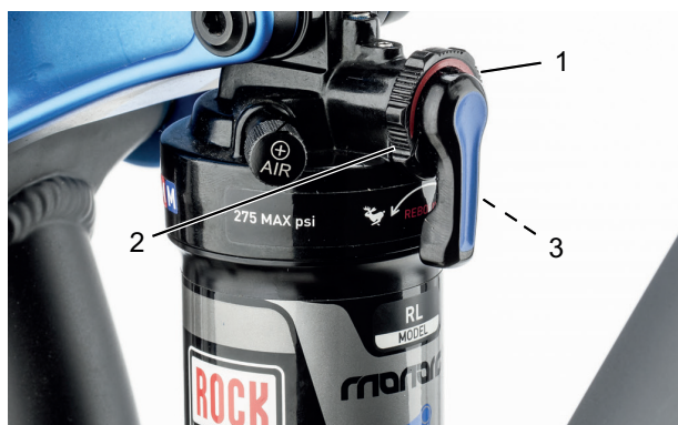
Abbildung 77: Härte des Zugstufen-Dämpfers am Einstellrad (1) des Hinterbau-Dämpfers einstellen
