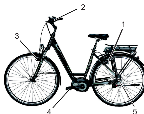
Abbildung 12: Bremssystem eines Pedelecs mit einer Rücktrittbremse, Beispiel
