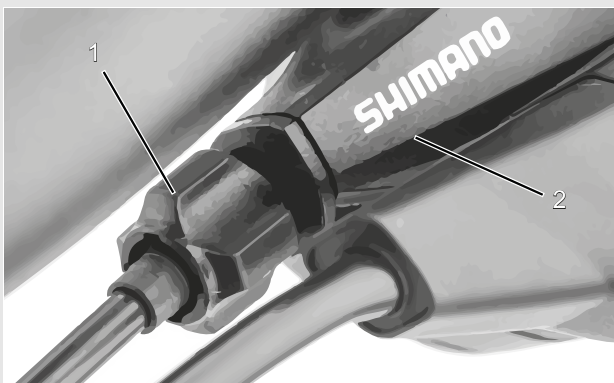
Obr. 86: Seřizovací pouzdro (1) řazení převodů ovládané jedním lankem s řadicí páčkou (2) - příklad
