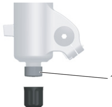
Obr. 60: Nastavovací šroub odskoku FOX na vidlici (1)
