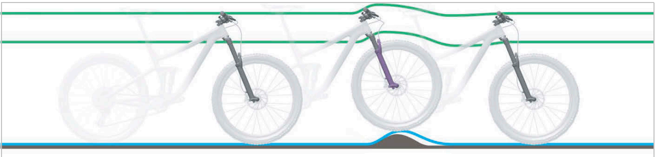
194. ábra: A teleszkópos villa túl kemény csillapítása egyenetlenségeknél
