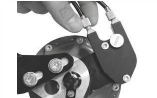
182. ábra: Külső váltóvezérléssel rendelkező ROHLOFF agyváltozatok húzásbeállítója a kötődobozon van, ami a bal oldalon található
