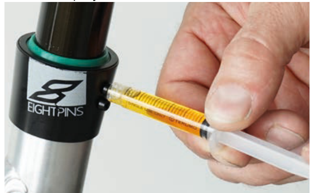
Figur 163: Smøring af eightpins-sadelpind
