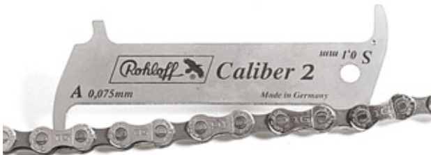
Figur 172: Eksempel på målelære fra ROHLOFF
