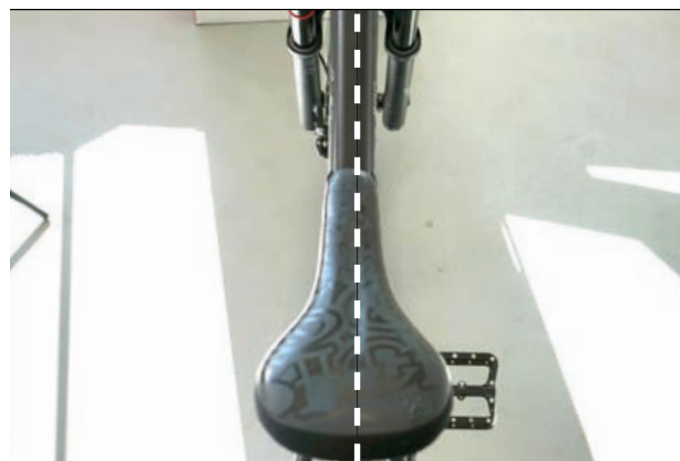
Figur 95: Justering af sadel i kørselsretningen
