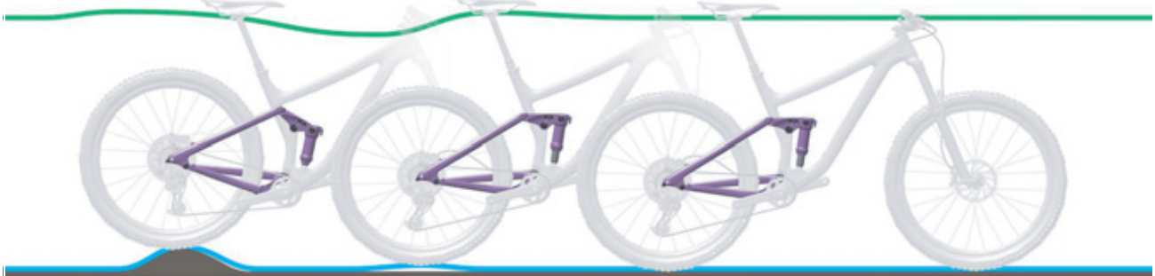
Figur 225: For hurtig tilbagefjedring på bagdæmperen
