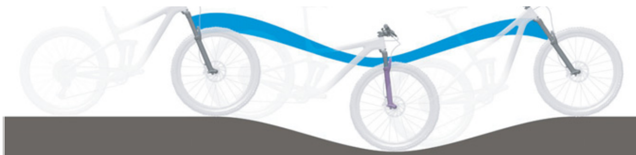
Figur 203: Fjedergaflens affjedring er for blød på bakker
