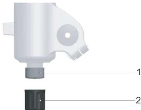
Figur 216: FOX-træktrinsskrue (1) under gaffelkappe (2)
