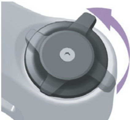
Figur 214: Blødere indstilling af tryktrinsindstillingsanordningen
