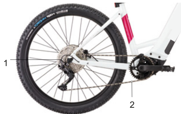
Figur 31: Oversigt over kædedrev med kædegearskift
