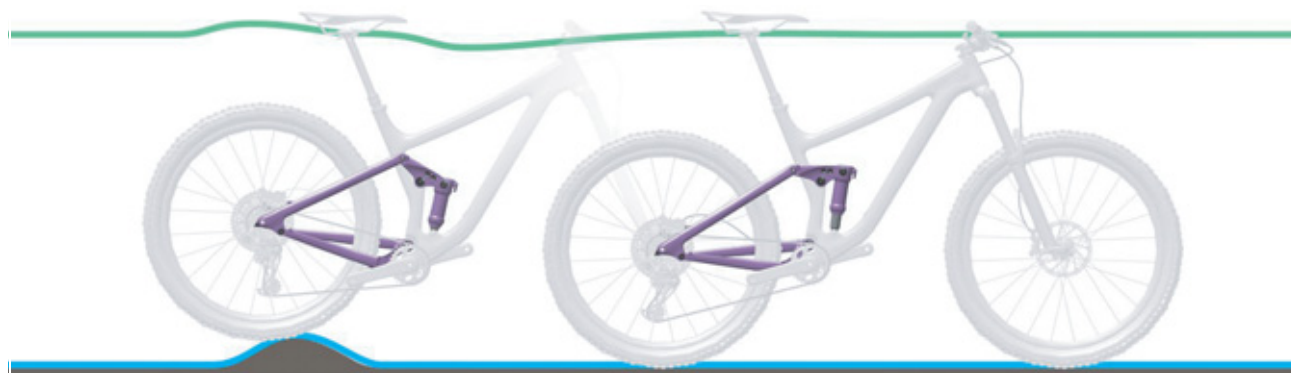
Figur 125: Bagdæmperen fungerer optimalt ved ujævnheder
