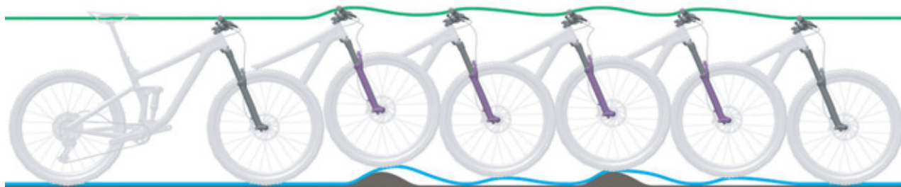
Figur 199: Fjedergaflen fjedrer for hurtigt tilbage
