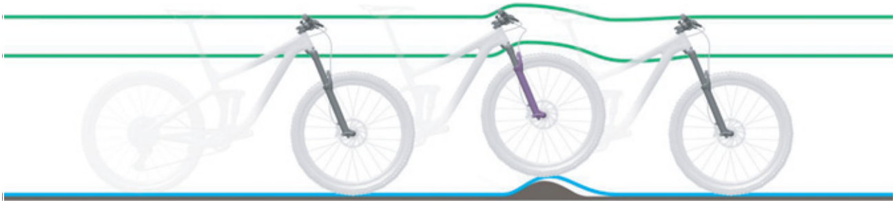
Figur 205: For hård dæmpning af fjedergafflen ved ujævnheder
