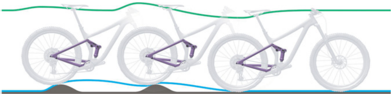
Figur 227: For langsom tilbagefjedring på bagdæmperen
