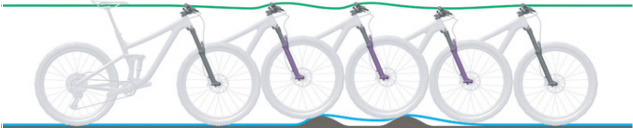
Figur 209: Fjedergaflen fjedrer for langsomt tilbage
