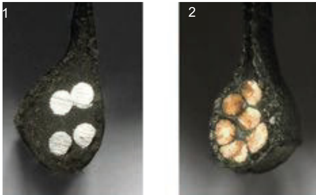
Figur 19: Stålkerner (1) og kevlarkerner (2)
