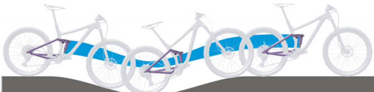
Figur 229: Bagdæmperens affjedring er for blød på bakker
