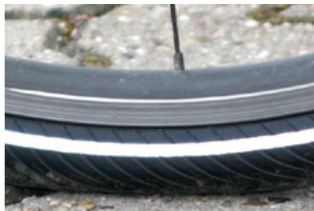
Figur 112: Korrekt dæktryk. Dækkets form er næsten ikke ændret af kropsvægtens belastning
