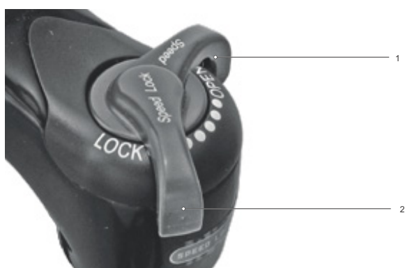
Figur 204: Hårdere indstilling på tryktrinsindstillingsanordning
