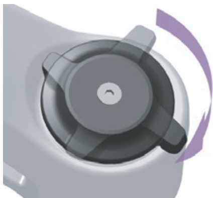
Figur 212: Hårdere indstilling på tryktrins-indstillingsanordning
