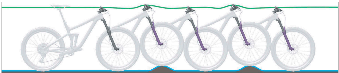
Afbeelding 12: Optimaal rijgedrag van de verende voorvork
