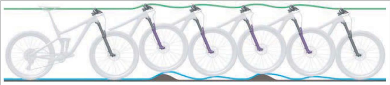
Afbeelding 188: Te snel uitveren van de verende voorvork
