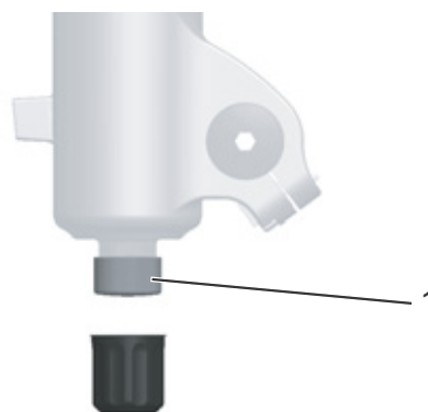
Obr. 63: Nastavovací šroub odskoku FOX na vidlici (1)
