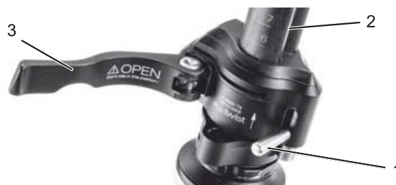
Obr. 71: Otevřená upínací páka rychloupínáku (3) na představci (2), provedení I, s pojistnou pákou na představci (1)
