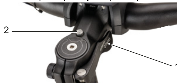
Obr. 72: Představec, provedení II s upínací pákou rychloupínáku představce (1) a odblokovacím knoflíkem (2)
