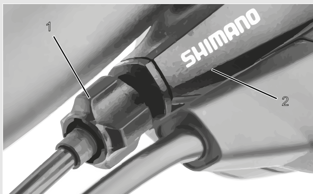
Obr. 97: Seřizovací pouzdro (1) řazení převodů ovládané jedním lankem s řadicí páčkou (2) - příklad
