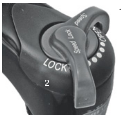
Obr. 87: Nastavovací šroub komprese Suntour s polohami OPEN (1) a LOCK (2)
