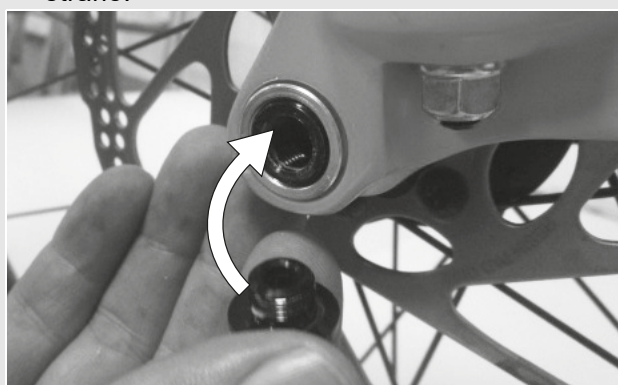
Obr. 30: Zasuňte páku rychloupínáku do osy
