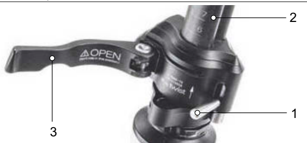
Illustration 50 : Levier de serrage ouvert de l'attache rapide de la potence (3) sur la potence (2), modèle I, avec levier de blocage sur la potence (1)
