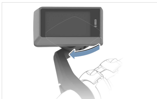
Illustration 93 : Tourner l'écran dans le sens des aiguilles d'une montre
