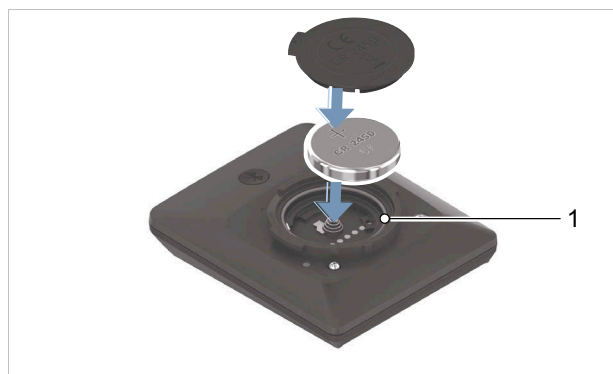
Illustration 91 : Insérer la pile en veillant à la position du joint (1)
