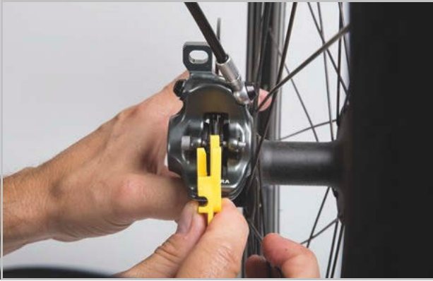
Illustration 130 : Contrôler la plaquette de frein montée à l'aide de la cale de transport
