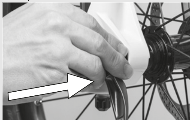
Figur 39: Skub hurtigbespændingen ind
