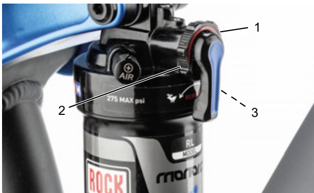
Figur 83: Indstilling af trækdæmperens hårdhed på bagdæmperens indstillingshjul (1)
