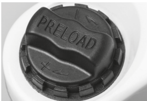
Figur 58: Indstillingshjulet til den negative fjedervandring på fjedergaflens krone
