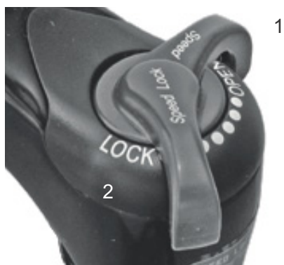
Figur 80: Suntour-trykindstillingsanordning med positionerne OPEN (1) og LOCK (2)
