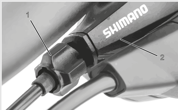
Figur 90: Slutmuffe (1) på gearskiftet med ét kabel og gearvælgerhus (2), eksempel
