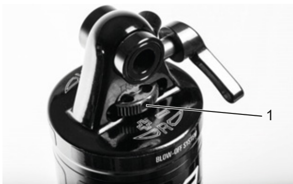
Figur 61: Hjul (1) for Suntour-træktrinsindstillingsanordning på bagdæmperen
