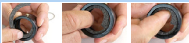
Figur 209: Ilægning af filtrering
