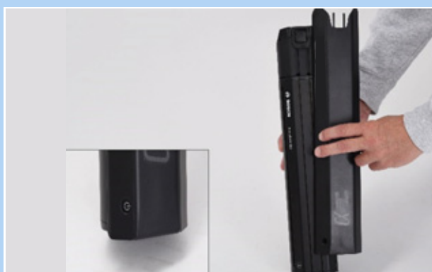
Figur 59: Skub batteridækslet på batteriet
