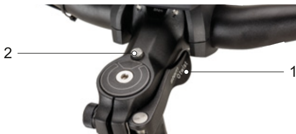
Figur 136: Frempind, udførelse II med greb på frempindens hurtigbespænding (1) og frigørelsesknap (2)
