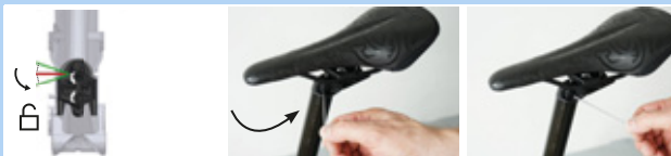
Figur 161: Sæt højdeindstillingsanordningen i "Åbnet stilling"
