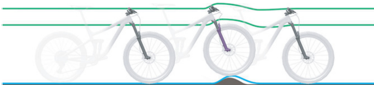
Figur 229: For hård dæmpning af fjedergafflen ved ujævnheder
