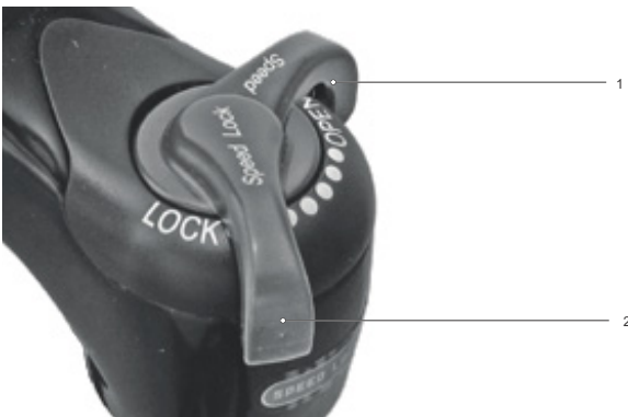
Figur 228: Hårdere indstilling på tryktrinsindstillingsanordning
