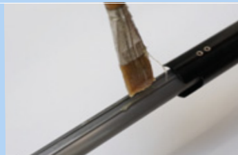
Figur 215: Påføring af fedt
