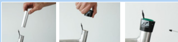
Figur 185: Montering af glidebøsning og udvendig kappe
