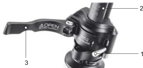
Figur 135: Åbnet greb på hurtigbespændingen (3) på frempinden (2), udførelse I, med låsegreb på frempinden (1)
