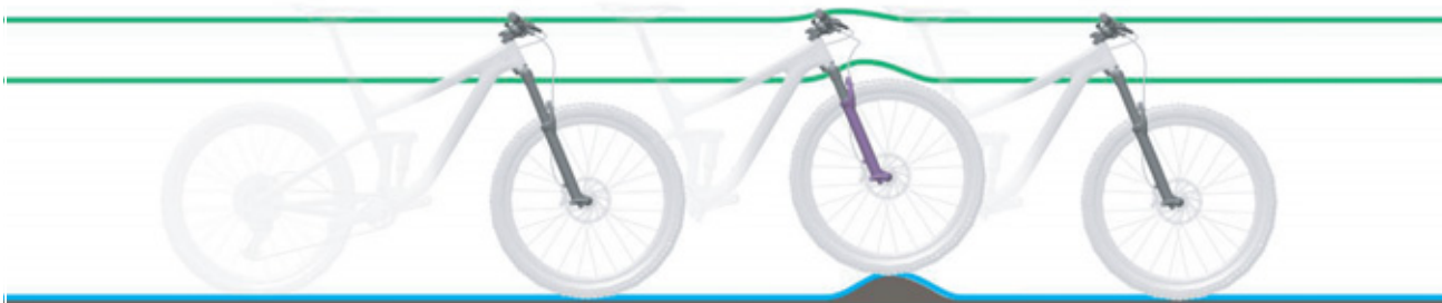
Figur 10: Gafflen kører optimalt ved ujævnheder
