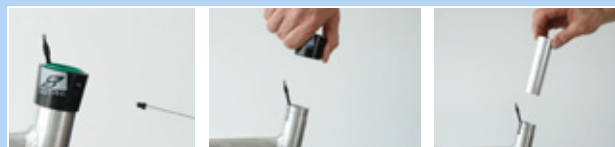
Figur 203: Afmontering af udvendig kappe og glidebøsning
