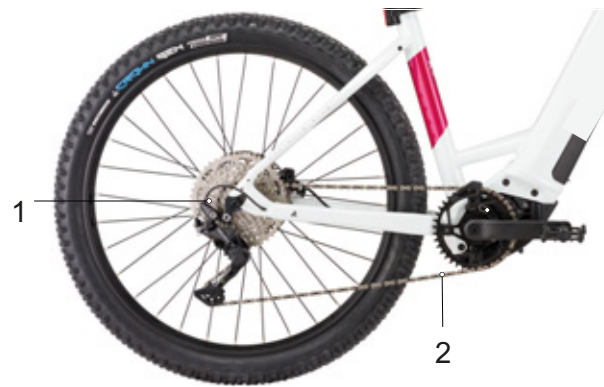
Figur 26: Oversigt over kædedrev med kædegearskift
