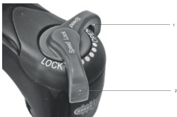
Figur 230: Blødere indstilling på tryktrins-indstillingsanordning
