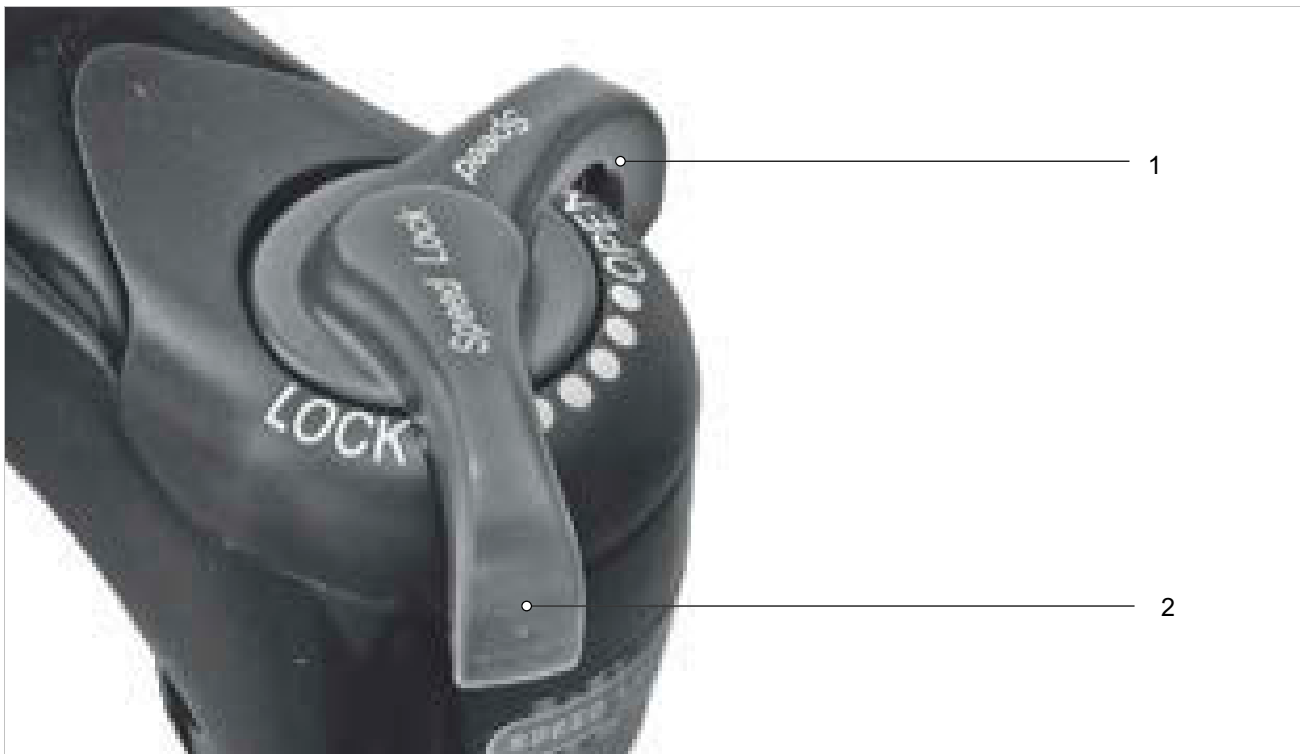
Afbeelding 135: SR SUNTOUR drukdemper in open (1) en gesloten (2) stand
