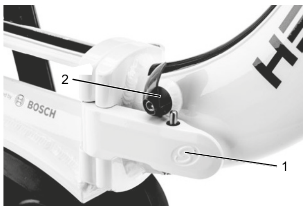
Afbeelding 140: Gesloten (1) en geopende (2) framevergrendelhendel
