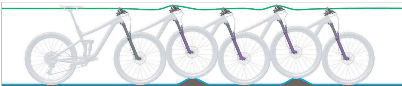
Afbeelding 15: Optimaal rijgedrag van de verende voorvork
