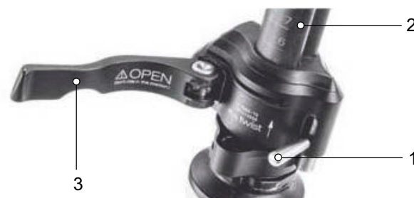
Afbeelding 138: Geopende spanhendel van de snelspanner (3) op de voorbouw (2), uitvoering I, met vergrendelhendel op de voorbouw (1)
