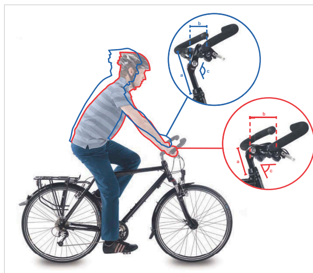
Afbeelding 97: Stadsfiets- (blauw) en toerfietsstand (rood) door verandering van de hoek
