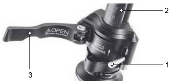
Afbeelding 71: Geopende spanhendel van de snelspanner (3) op de voorbouw (2), uitvoering I, met vergrendelhendel op de voorbouw (1)
