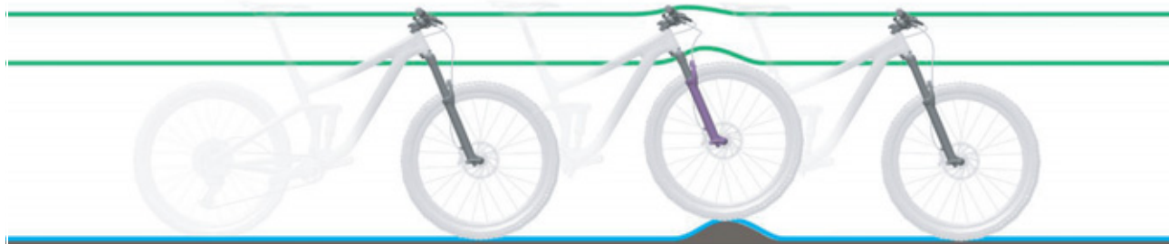
Figur 148: Optimal kørsel ved ujævnheder
