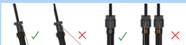
Figur 204: Korrekt og forkert bowdenkabel
