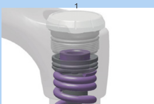
Figur 98: Drej forspændingsindstillingsringen ind og ud.
