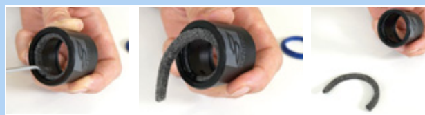
Figur 188: Fjernelse af filtring
