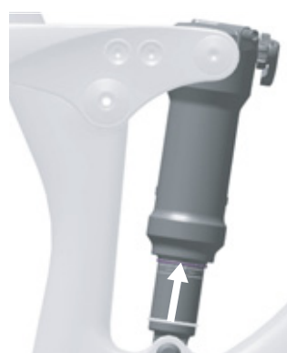
Figur 113: Forskyd O-ringen på bagdæmperen
