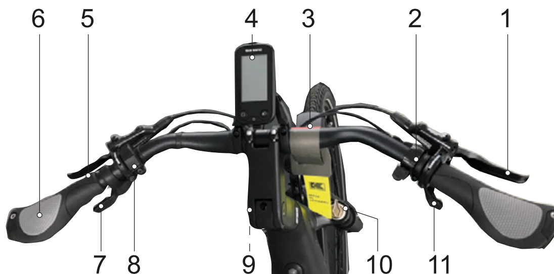
Figur 38: Detaljeret visning af styr med SHIMANO SC-E5003 cykelcomputer, eksempel
