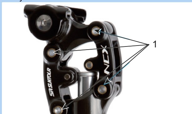
Figur 176: Smørepunkter på SR Suntour affjedret sadelpind
