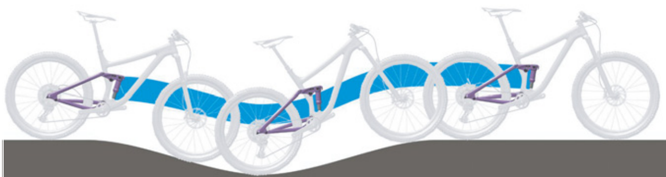
Figur 19: Bagdæmperen fungerer optimalt under kørsel i kuperet terræn
