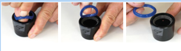
Figur 222: Udtrækning af afstryger
