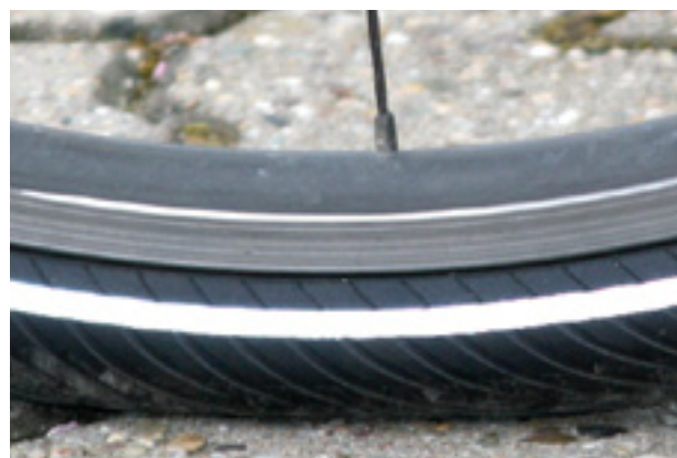
Figur 88: Korrekt dæktryk. Dækkets form er næsten ikke ændret af kropsvægtens belastning
