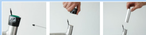
Figur 219: Afmontering af udvendig kappe og glidebøsning
