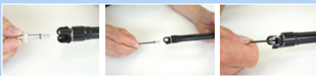
Figur 196: Fastgørelse af patronens ventildæksel
