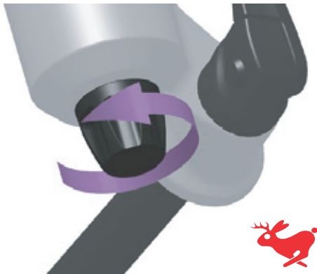
Figur 250: Drej træktrinsskruen hen mod haren
