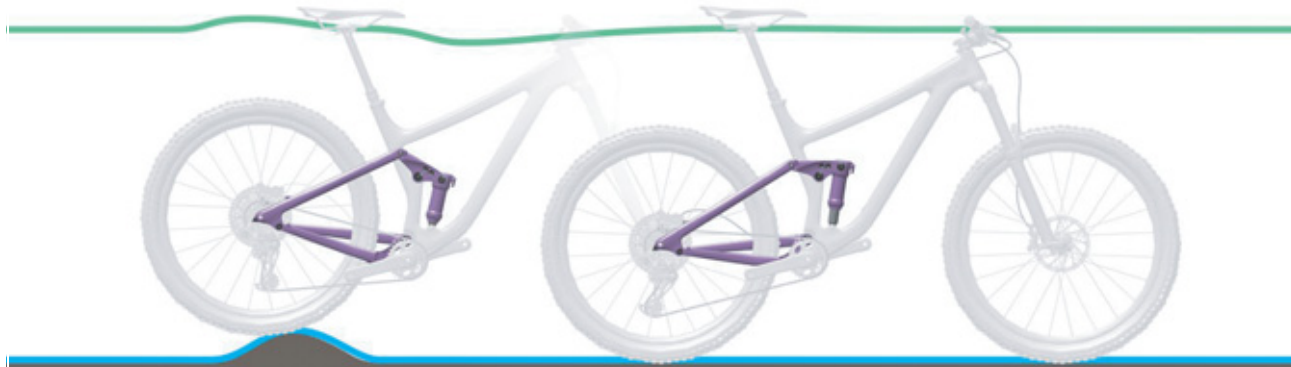
Figur 117: Bagdæmperen fungerer optimalt ved ujævnheder
