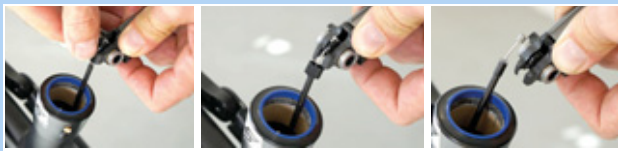
Figur 218: Fjernelse af bowdenkabel
