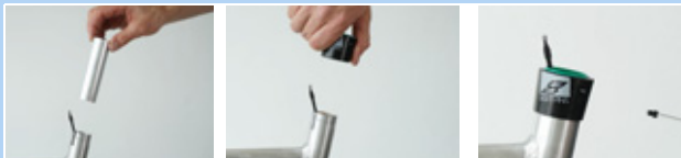
Figur 234: Montering af glidebøsning og udvendig kappe
