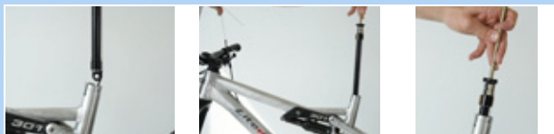
Figur 205: Fastgørelse af patronens ventildæksel
