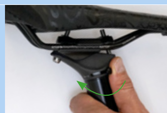
Figur 233: Lukning af højdeindstilling
