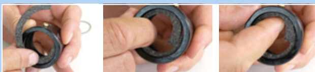
Figur 225: Ilægning af filtrering
