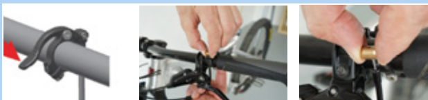
Figur 179: Afmontering af patron
