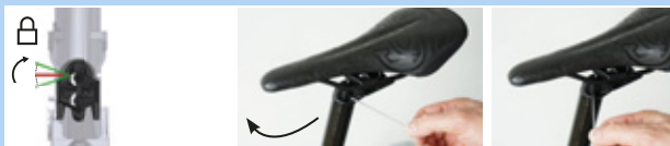
Figur 214: Lukning af højdeindstilling
