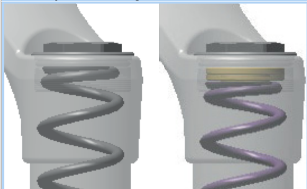
Figur 107: Drej forspændingsindstillingsringen ind og ud.
