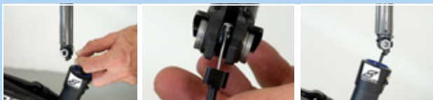
Figur 235: Påhægtning og indskubning af sadelpind
