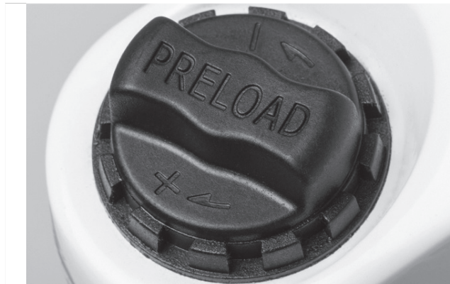
Abbildung 46: Einstellrad des Negativen Federwegs auf der Krone der Federgabel
