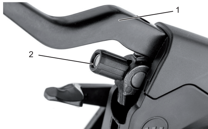
Abbildung 73: Bremshebel (1) der hydraulisch betätigten Felgenbremse mit Einstellschraube (2)
