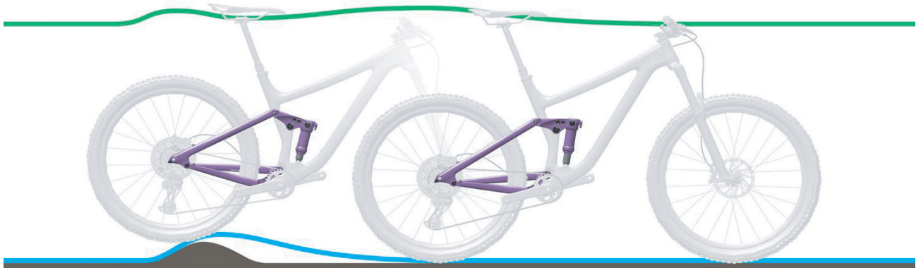
Abbildung 247: Zu harte Dämpfung des Hinterbau-Dämpfers bei Unebenheiten
