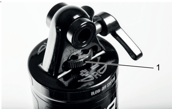
Abbildung 226: SR SUNTOUR-Zugstufen-Einsteller Rad (1) am Hinterbau-Dämpfer
