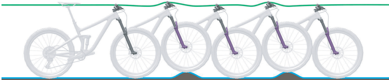
Abbildung 12: Optimales Fahrverhalten der Gabel
