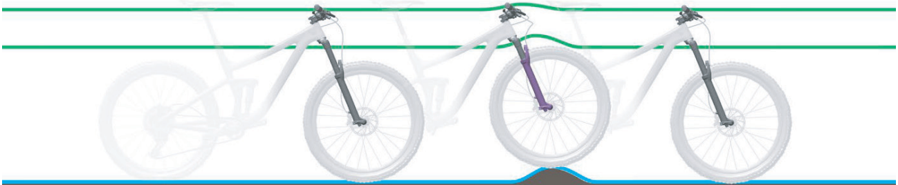
Abbildung 11: Optimales Fahrverhalten der Gabel bei Unebenheiten
