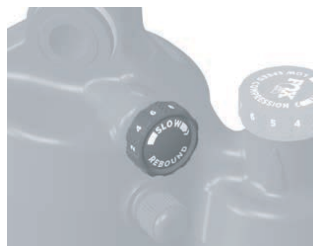
Abbildung 244: Zugstufeneinsteller Float DPS (1) und Float X (2)
