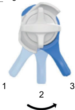
Abbildung 126: Einstellung des 3-Wege-Hebelss von geschlossen (1) über mittel (2) bis hin zu offen (3)
