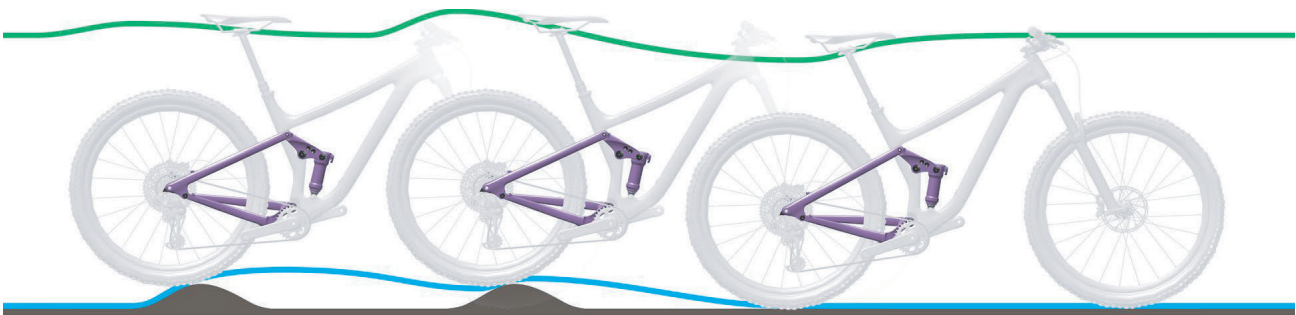
Abbildung 235: Zu langsames Ausfedern des Hinterbau-Dämpfers
