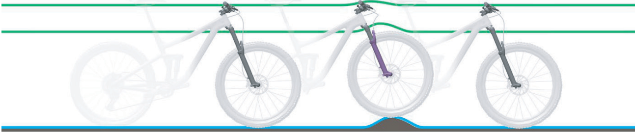
Abbildung 152: Optimales Fahrverhalten bei Unebenheiten
