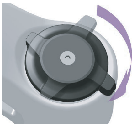
Abbildung 212: Druckstufeneinsteller härter einstellen
