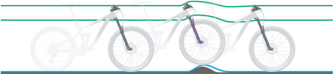
Abbildung 213: Zu harte Dämpfung der Federgabel bei Unebenheiten
