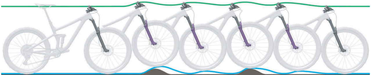
Abbildung 215: Zu schnelles Ausfedern der Federgabel
