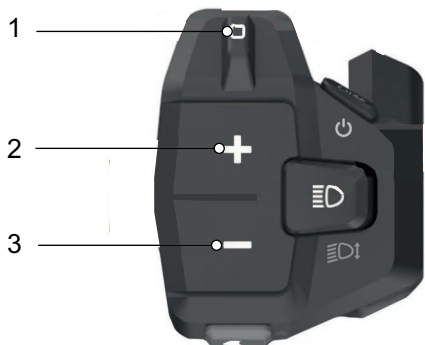
Abbildung 134: Lage Navigation Wippe (1), Plus- (2) und Minus (3) Taster I
