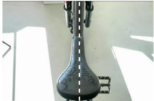
Abbildung 95: Sattel in Fahrtrichtung ausrichten
