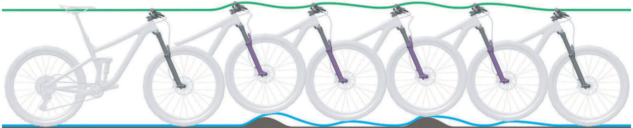
Abbildung 207: Zu schnelles Ausfedern der Federgabel
