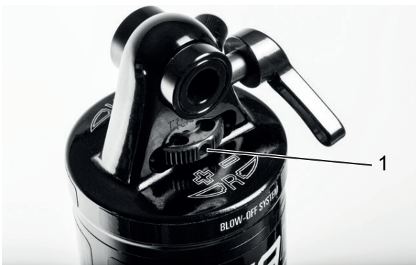
Abbildung 228: SR SUNTOUR-Zugstufen-Einsteller Rad (1) am Hinterbau-Dämpfer
