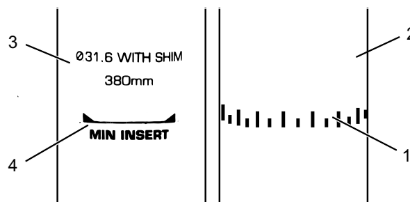
Abbildung 99: Detailansicht Sattelstützen, Beispiele für die Markierung der Mindesteinstecktiefe
