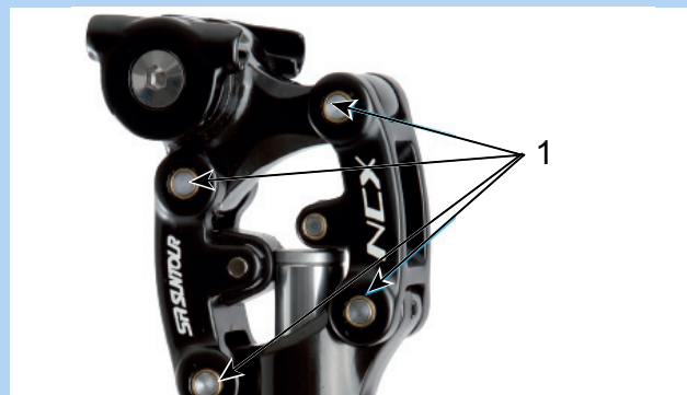
Abbildung 197: Schmierpunkte SR SUNTOUR Feder-Sattelstütze
