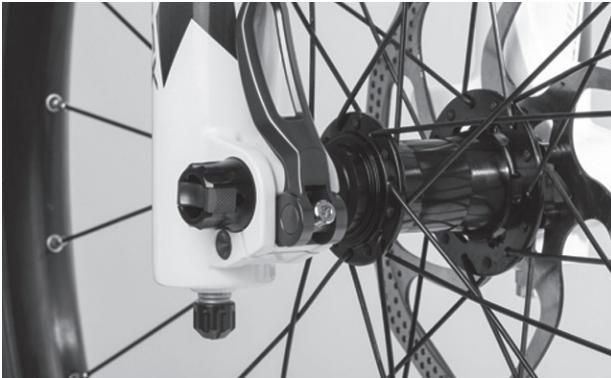
Abbildung 32: Perfekte Lage des Spannhebels
