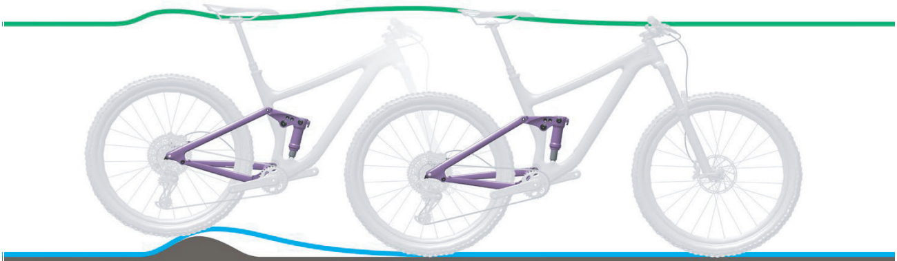
Abbildung 103: Zu harte Dämpfung des Hinterbau-Dämpfers bei Unebenheiten
