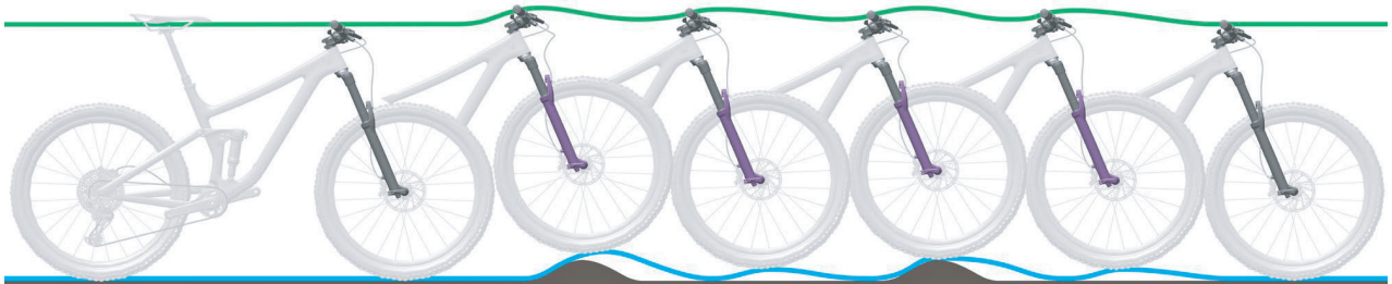
Abbildung 89: Zu schnelles Ausfedern der Federgabel
