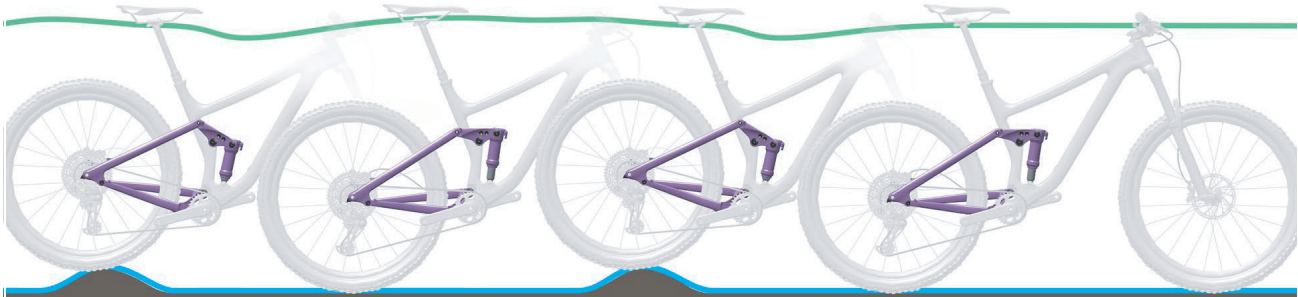
Abbildung 10: Optimales Fahrverhalten des Hinterbau-Dämpfers
