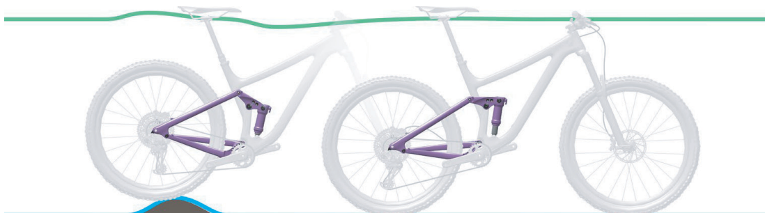
Abbildung 12: Optimales Fahrverhalten des Hinterbau-Dämpfers bei Unebenheiten
