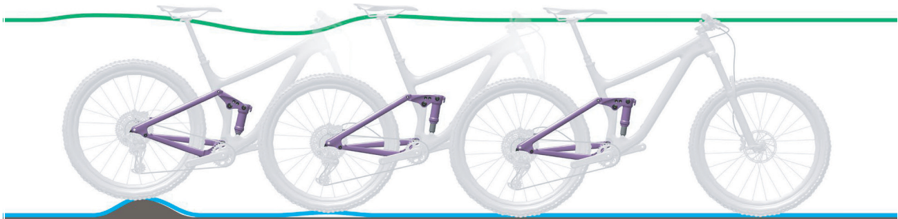
Abbildung 97: Zu schnelles Ausfedern des Hinterbau-Dämpfers
