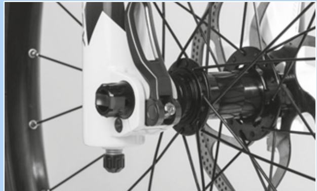
Figur 199: Indstilling af hurtigbespændingens spændekraft
