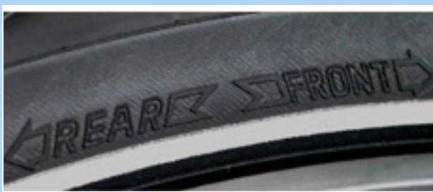
Figur 70: Køreretningspil på MTB-dæk
