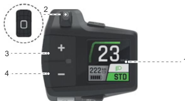
Figur 137: Skærm (1) på FIT Remote med LCD
