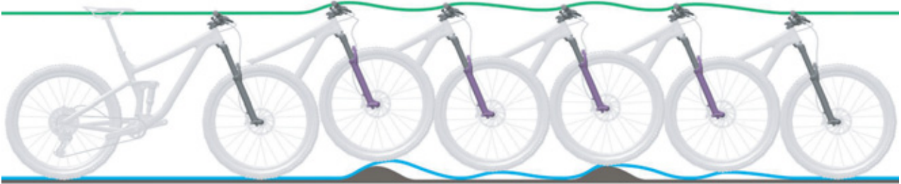
Figur 203: Fjedergaflen fjedrer for hurtigt tilbage
