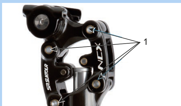
Figur 201: Smørepunkter på SR SUNTOUR affjedret sadelpind
