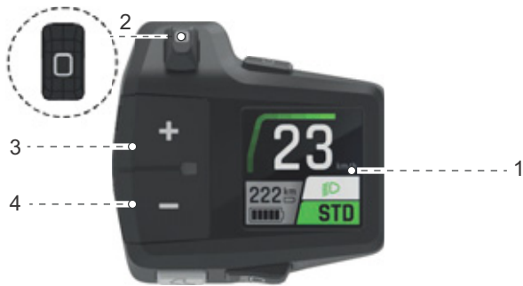
Figur 44: Skærm (1) på FIT Remote med LCD
