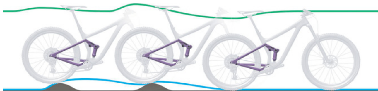
Figur 229: For langsom tilbagefjedring på bagdæmperen
