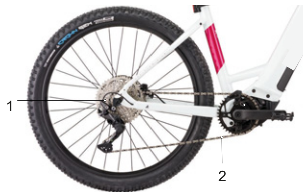
Figur 37: Oversigt over kædedrev med kædegearskift
