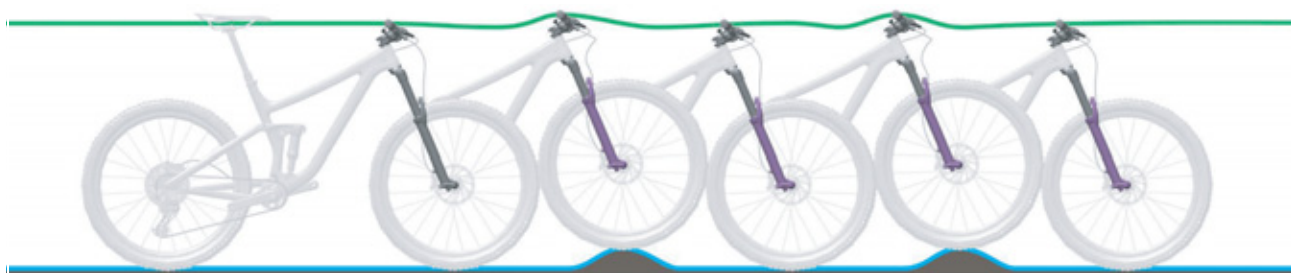
Figur 131: Gafflens optimale køremåde
