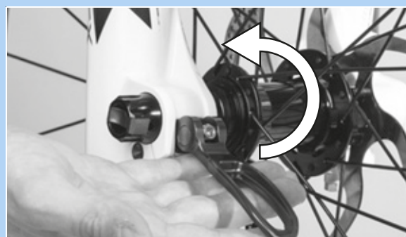
Figur 78: Hurtigbespændingsgrebet trykkes i pilens retning
