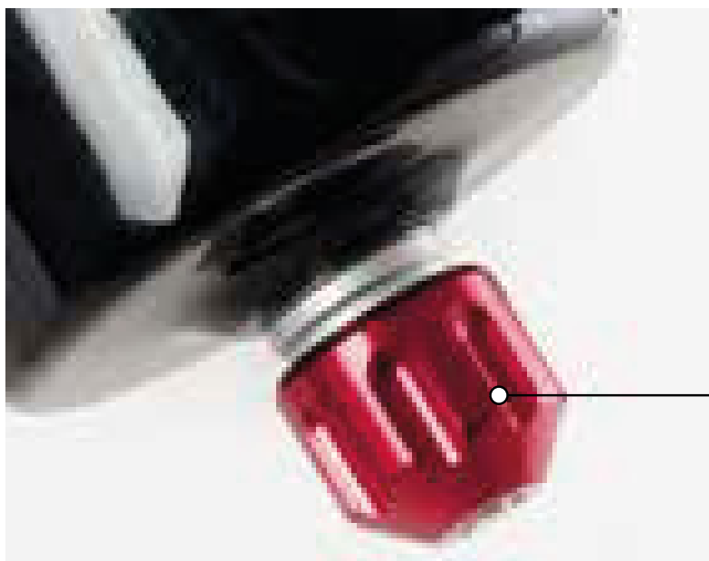
Figur 132: Eksempel på SR SUNTOUR-træktrinsskrue (1)
