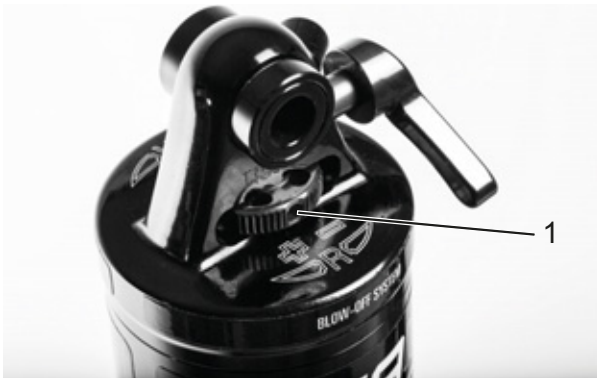
Figur 220: SR SUNTOUR-træktrins-indstillingsanordning hjul (1) på bagdæmperen
