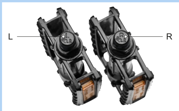
Figur 90: Eksempel på mærkning af pedaler
