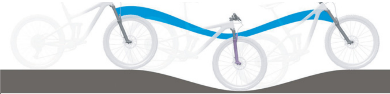
Obr. 74: Příliš měkké odpružení odpružené vidlice v horách
