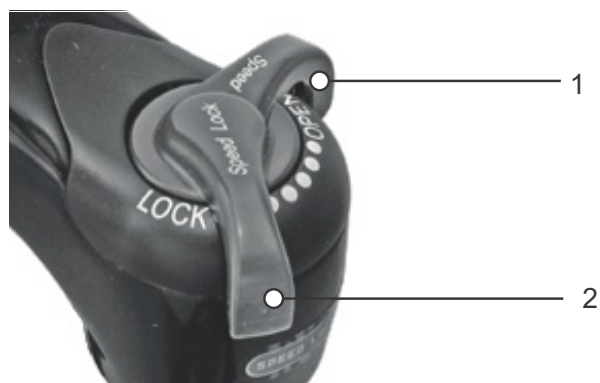
Obr. 62: Tlumič komprese Suntour v otevřené (1) a zavřené (2) poloze
