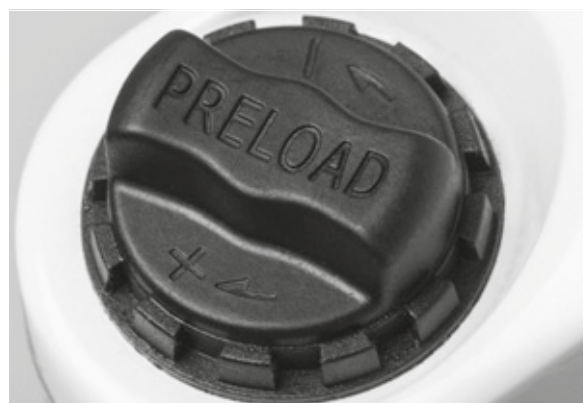
Obr. 40: Nastavovací kolečko SAG na korunce odpružené vidlice
