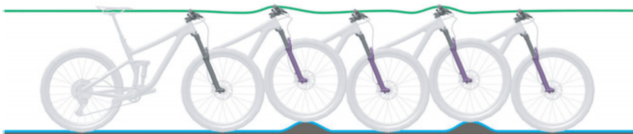
Obr. 42: Optimální chování vidlice při jízdě
