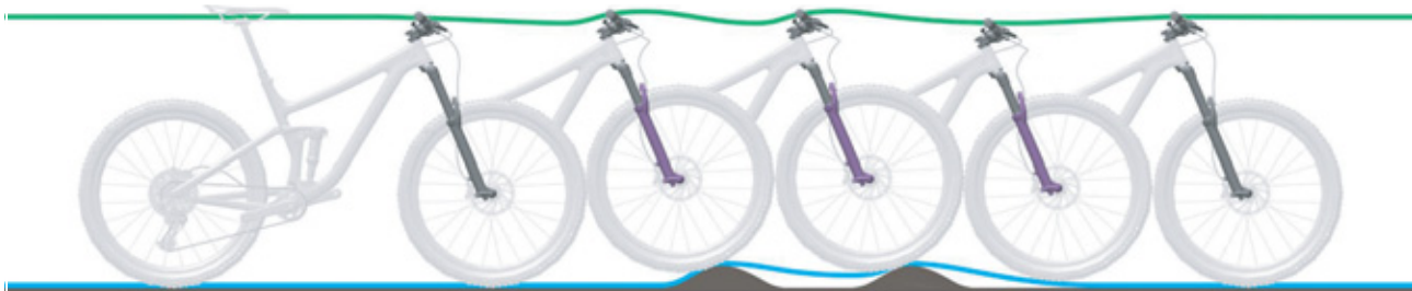
Obr. 72: Příliš pomalé roztahování odpružené vidlice
