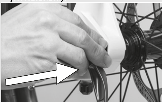
Rysunek 35: Wsuwanie zacisku szybko mocującego
