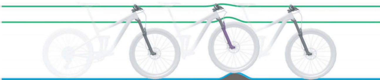
Rysunek 7: Optymalne działanie widełca podczas jazdy po nierównościach
