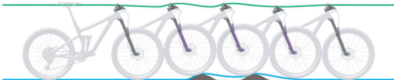
Rysunek 91: Zbyt wolne rozprężanie widelca amortyzowanego
