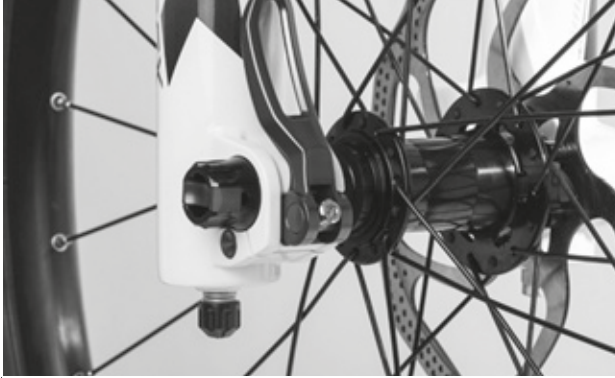
Rysunek 84: Ustawianie siły mocowania zacisku szybkomocującego
