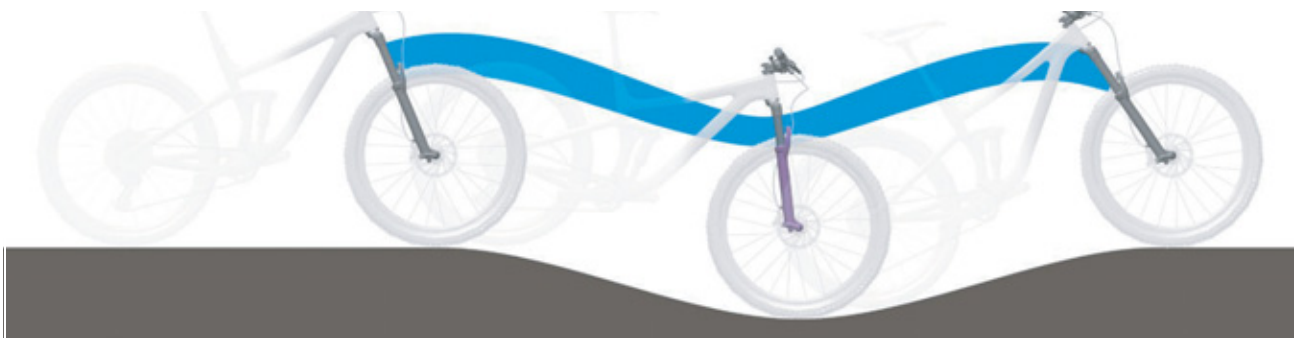
Rysunek 6: Optymalne działanie widełca na pagórkowatym terenie
