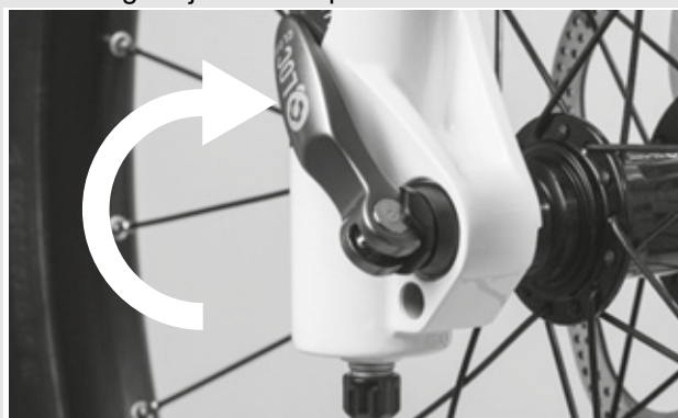
Rysunek 37: Zamykanie zacisku szybko mocującego
