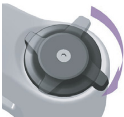
Rysunek 94: Ustawienie nastawnika dobicia na twardszy tryb pracy
