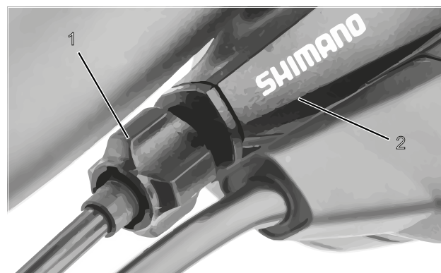
Rysunek 86: Nakrętka regulacyjna (1) jednocięgowego mechanizmu zmiany przerzutek z obudową dźwigni zmiany biegów (2), przykład
