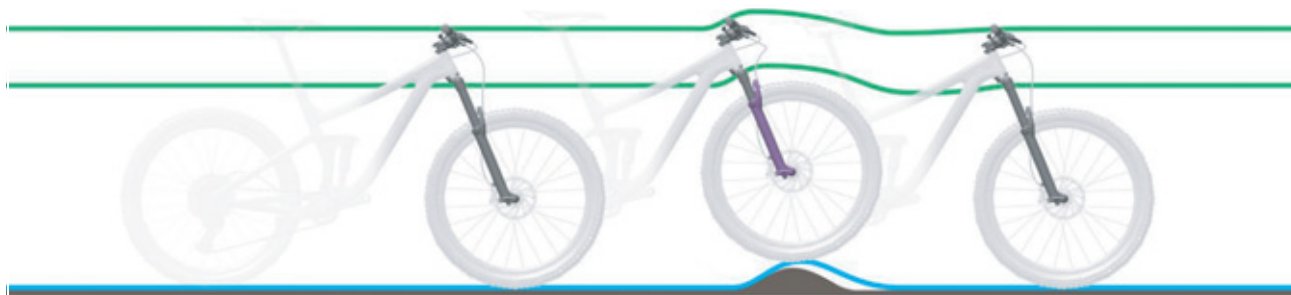
Rysunek 95: Zbyt twarde tłumienie widelca amortyzowanego na nierównościach
