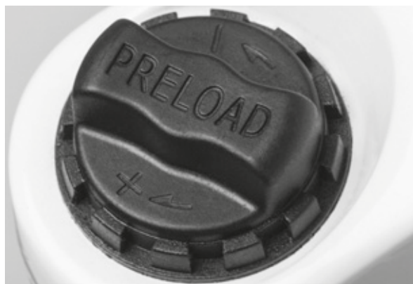
Rysunek 53: Pokrętko regulacyjne parametru SAG usytuowane na koronie widelca amortyzowanego
