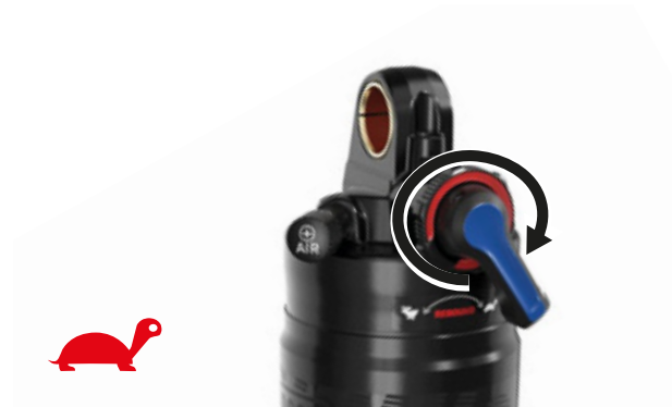
Rysunek 66: Zmniejszanie szybkości rozprężania
