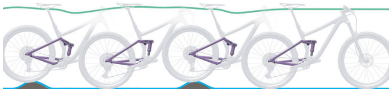
Rysunek 10: Optymalne działanie tylnego amortyzatora
