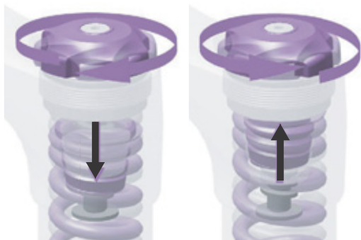
Rysunek 55: Przykręcanie i odkręcanie pierścienia regulacji naprężenia wstępnego.
