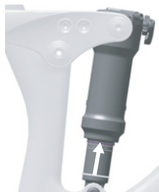
Rysunek 60: Przesuwanie pierścienia o-ring na tylnym amortyzatorze
