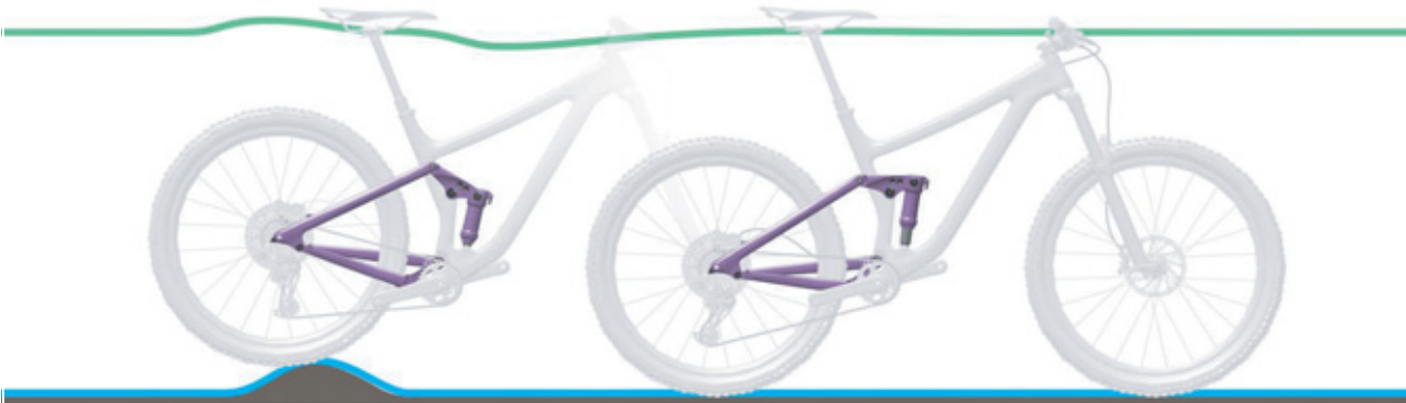
Rysunek 69: Optymalne działanie tylnego amortyzatora na nierównościami
