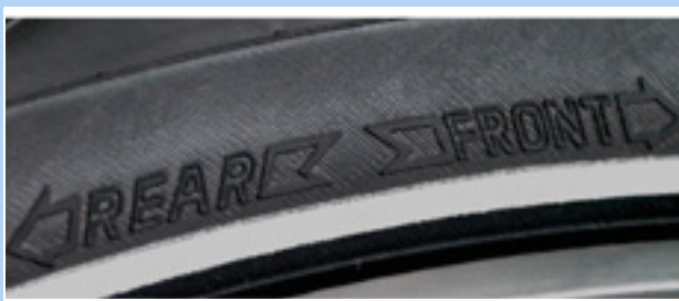
Obr. 60: Šipka označující směr jízdy na pláštích MTB
