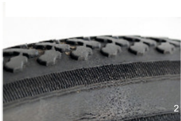
Obr. 166: Příklady únavových trhlin (1) a trhlin vzniklých stárnutím (2)
