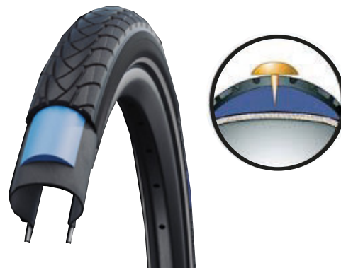
Obr. 20: Účinek ochranného pásu proti propíchnutí
