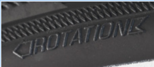
Obr. 59: Šipka označující směr jízdy
