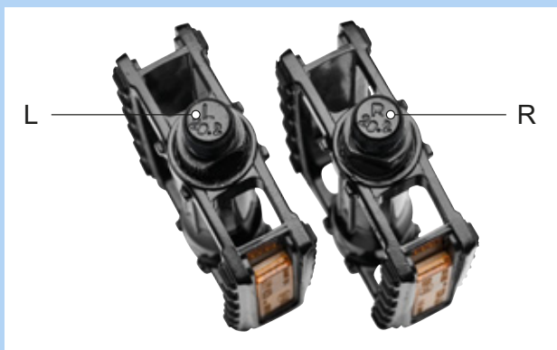
Obr. 80: Příklad označení pedálů
