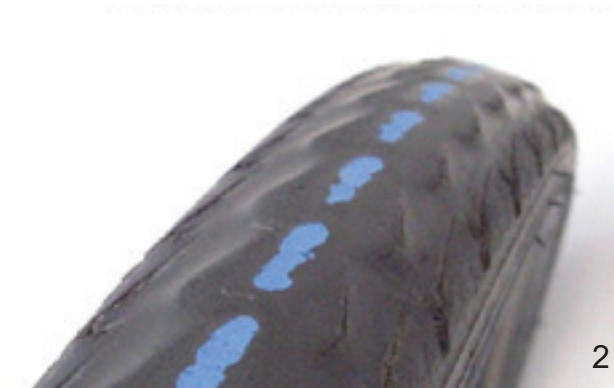
Obr. 165: Plášť bez profilu, který může být vyměněn (1), a plášť s proraženou ochranou (2), který je třeba vyměnit
