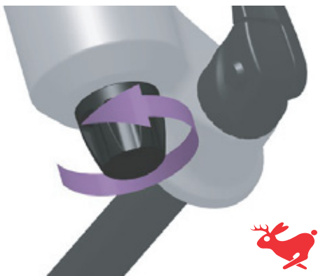
Obr. 210: Otočení šroubu odskoku směrem k zajíci
