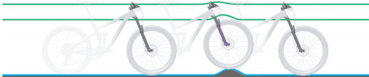
Obr. 152: Optimální chování při jízdě u nerovnosti
