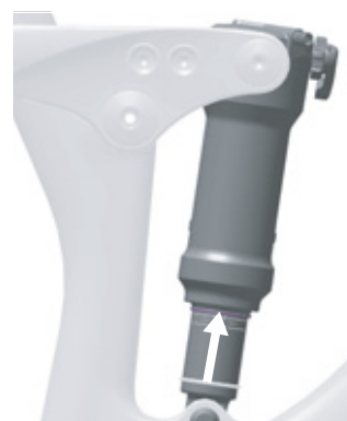
Figura 104: Spostamento dell'O-ring sull'ammortizzatore del carro posteriore
