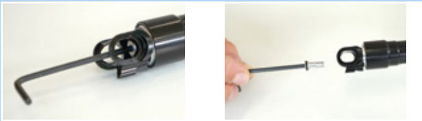
Figura 186: Svitamento del cappuccio della valvola
