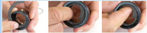
Figura 214: Applicazione dell'anello di feltro
