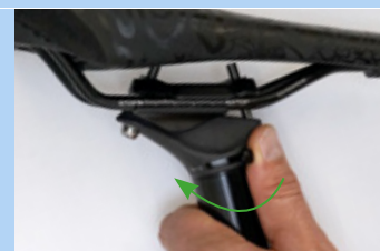
Figura 222: Chiusura della regolazione in altezza
