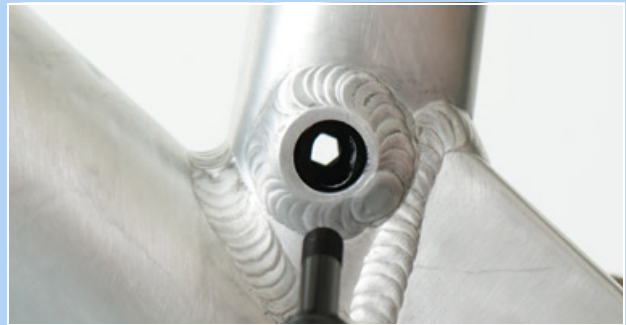
Figura 226: Foro dell'interfaccia Postpin
