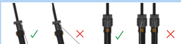
Figura 193: Cavo meccanico corretto ed errato
