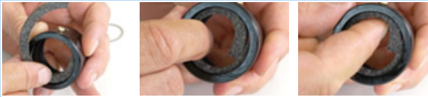
Figura 179: Applicazione dell'anello di feltro
