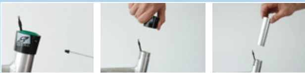
Figura 174: Smontaggio della boccola esterna e del manicotto scorrevole
