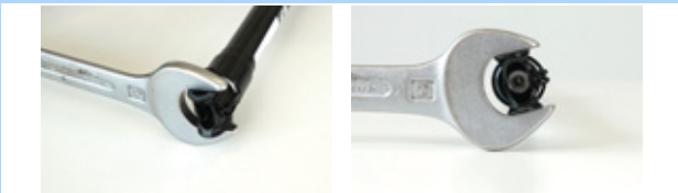
Figura 187: Bloccaggio per impedire la rotazione
