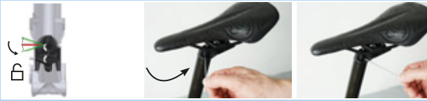
Figura 166: Posizionamento dell'azionamento della regolazione in altezza in posizione orizzontale
