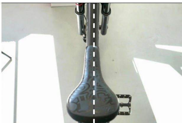
Figura 62: Posizionamento della sella in direzione di marcia
