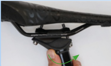
Figura 217: Apertura della regolazione in altezza
