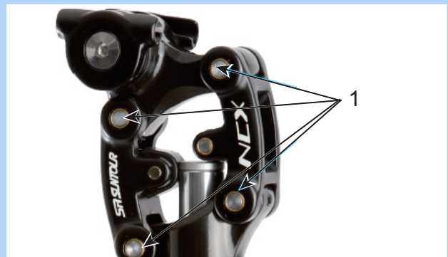
Figura 165: Punti di lubrificazione del cannotto reggisella ammortizzato SR Suntour
