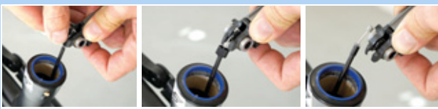
Figura 207: Rimozione del cavo meccanico
