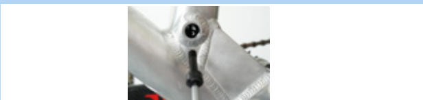
Figura 169: Sbloccaggio del perno Postpin
