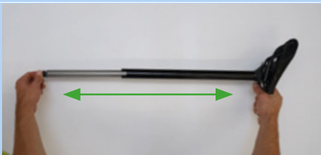
Figura 218: Estrazione completa del tubo del canotto reggisella
