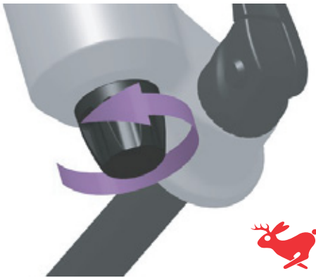
Figura 231: Ruotare la vite del rebound in direzione della lepre
