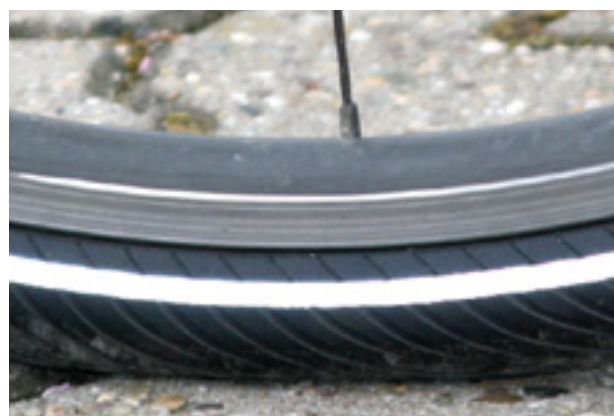
Figura 79: Corretta pressione di gonfiaggio. Lo pneumatico quasi non si deforma sotto il peso corporeo
