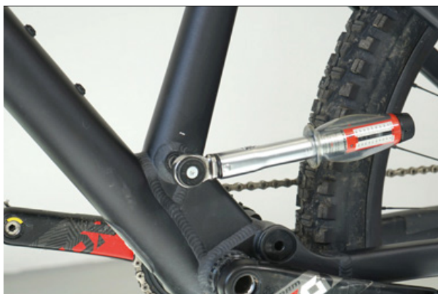
Figura 63: Serraggio dell'asse del canotto reggisella
