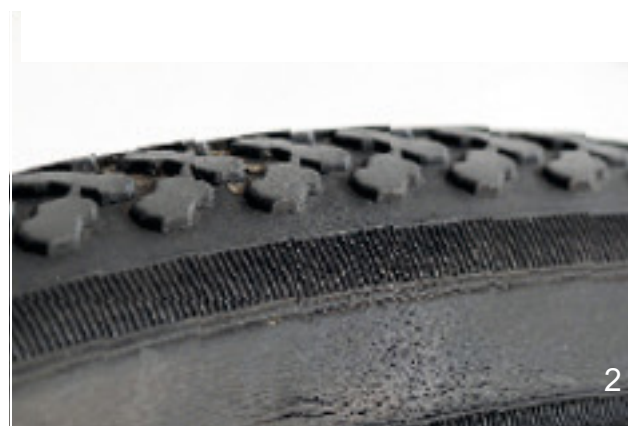
Figura 154: Esempi di crepe da fatica (1) e da invecchiamento (2)
