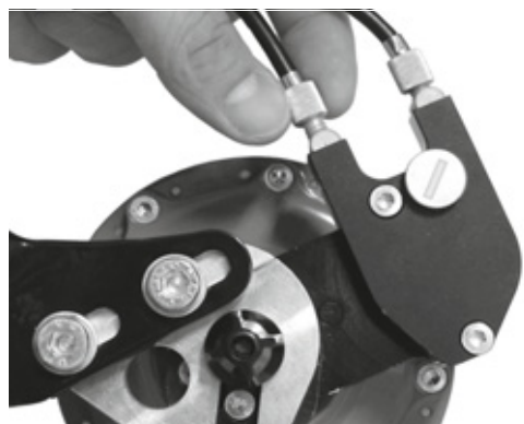
Obr. 154: Náboje Rohloff s externím ovládním řazení mají seřizovače napnutí na lanovodu, který je umístěn na levé straně
