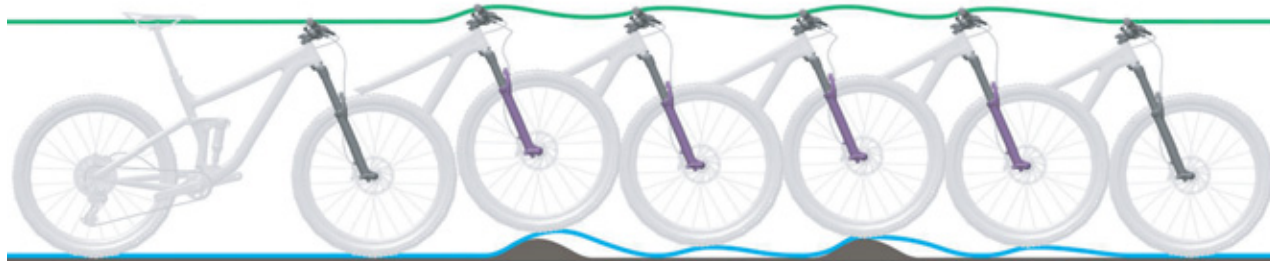
Obr. 223: Příliš rychlé roztahování odpružené vidlice
