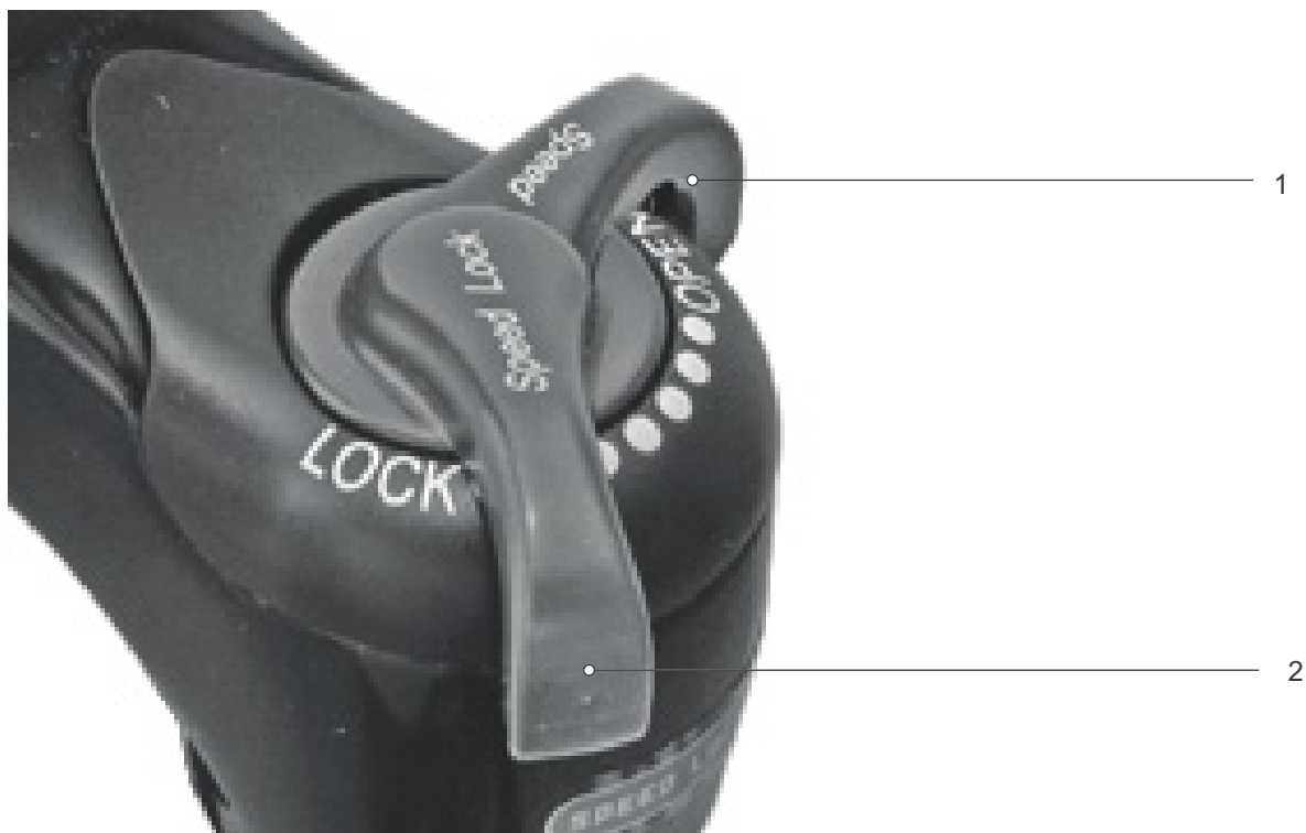
Obr. 130: Tlumič komprese Suntour v otevřené (1) a zavřené (2) poloze
