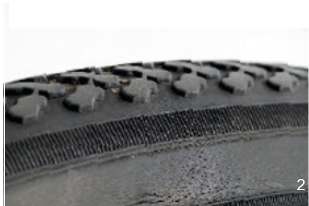
Obr. 149: Příklady únavových trhlin (1) a trhlin vzniklých stárnutím (2)
