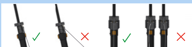
Obr. 188: Správné a nesprávné vedení bovdenů
