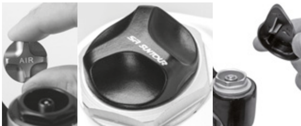
Obr. 108: Šroubovací krytka může mít různé provedení
