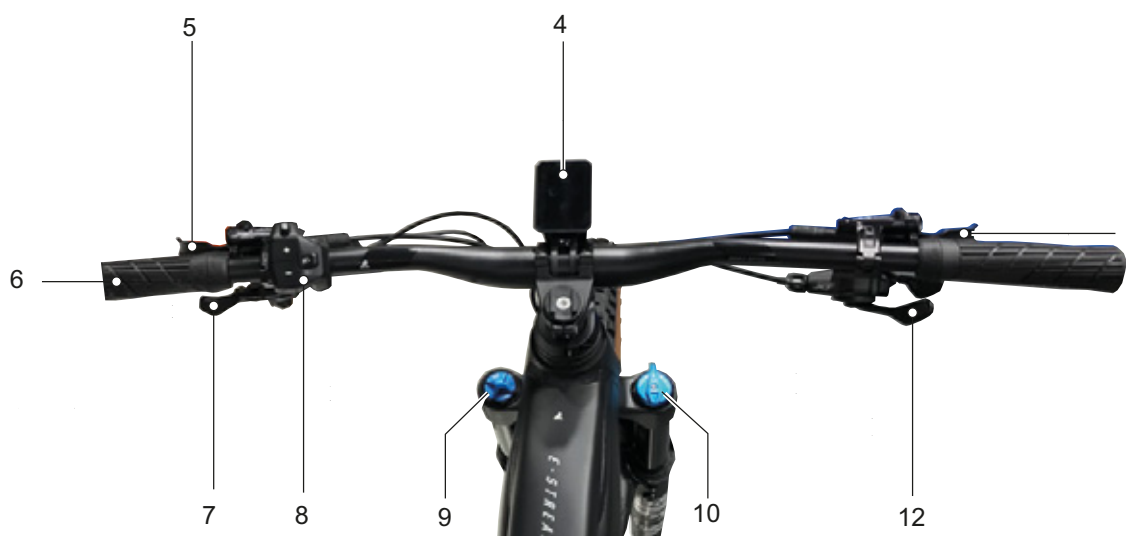
Obr. 32: Detailní pohled Řídítka s palubním počítačem BOSCH Intuvia, příklad
