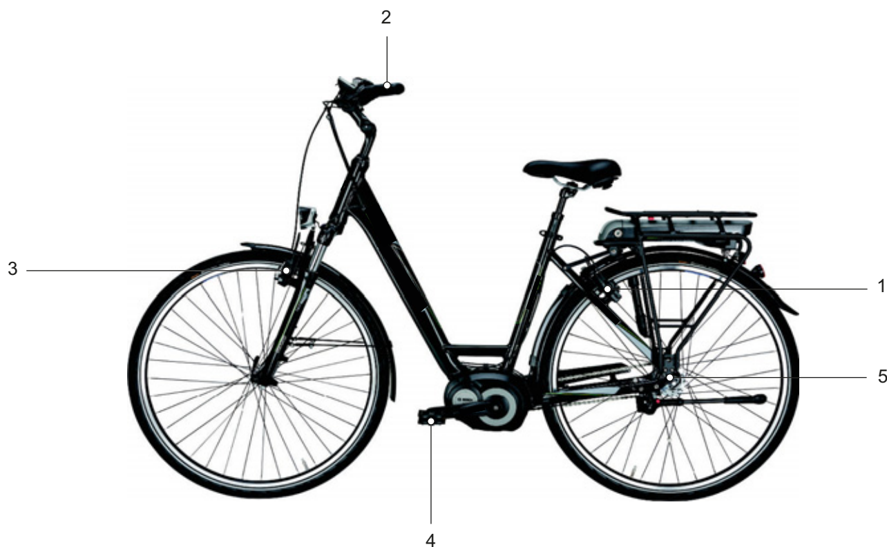
Obr. 22: Příklad brzdového systému s brzdou zpětným sešlápnutím
