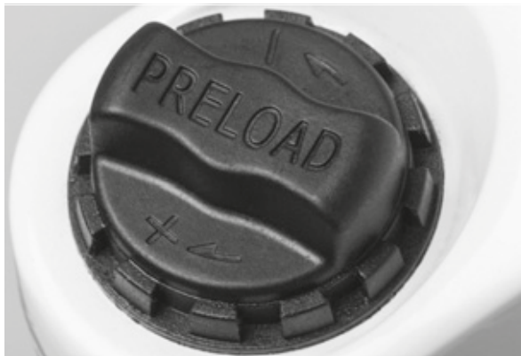
Afbeelding 56: Afstelwiel voor de negatieve veerweg op de kroon van de verende voorvork
