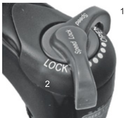
Afbeelding 75: Suntour-drukdemperafsteller met de standen OPEN (1) en LOCK (2)
