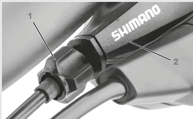
Afbeelding 85: Afstelwartel (1) van de versnelling met enkele bowdenkabelbediening en behuizing van de schakelhendel (2), voorbeeld
