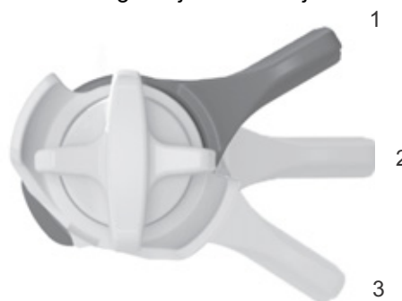
Afbeelding 73: FOX-drukdemperafsteller op de achterbouwdeemper met de standen OPEN (1), MIDDEL (2) en HARD (3)
