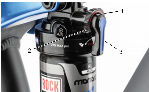
Afbeelding 78: Hardheid van de trekdemper afstellen met het afstelwiel (1) van de achterbouwdemper
