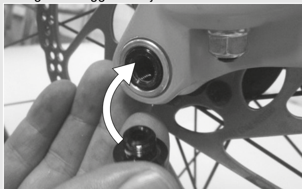
Afbeelding 28: Snelspanhendel in as schuiven
