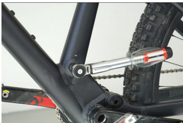
Rysunek 75: Dociąganie osi sztycy podsiodłowej
