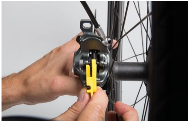
Rysunek 140: Sprawdzenie stanu klocków hamulca w stanie zamontowanym za pomocą zabezpieczenia transportowego
