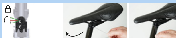
Rysunek 188: Zamykanie mechanizmu regulacji wysokości
