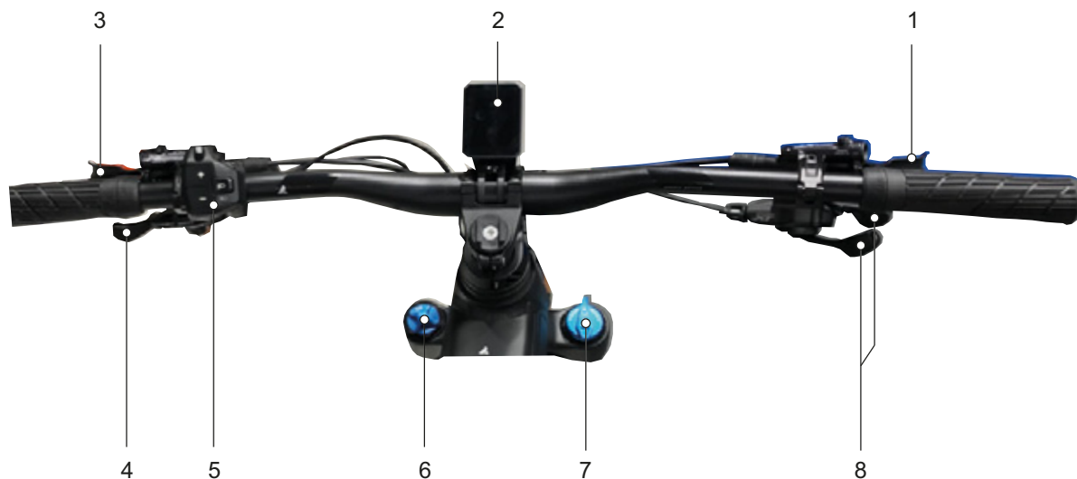
Rysunek 35: Widok szczegółowy kierownicy z komputerem pokładowym SC-E800 firmy SHIMANO
