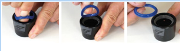
Rysunek 161: Wyciąganie zgarniacza
