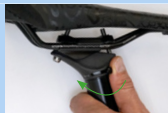
Rysunek 207: Zamykanie mechanizmu regulacji wysokości
