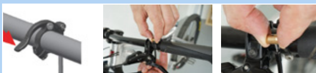
Rysunek 153: Demontaż wkładu
