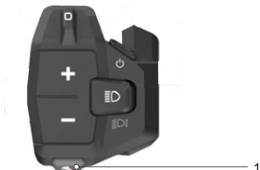
Rysunek 123: Położenie przycisku mechanizmu wspomagającego pchanie
