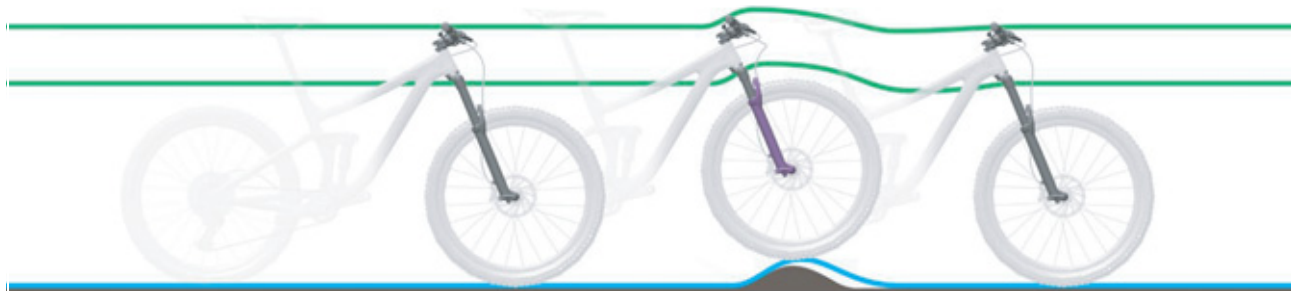
Rysunek 219: Zbyt twarde tłumienie widełca amortyzowanego na nierównościach
