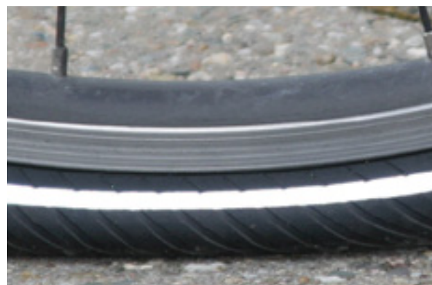
Rysunek 92: Zbyt niskie ciśnienie w oponie
