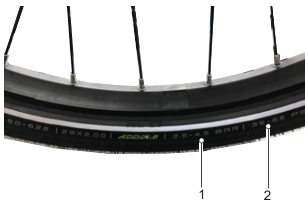
Rysunek 137: Ciśnienie w oponach w barach (1) i psi (2)
