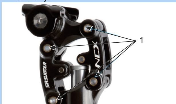
Rysunek 150: Punkty smarowania amortyzowanej sztycy podsiodłowej Suntour SR
