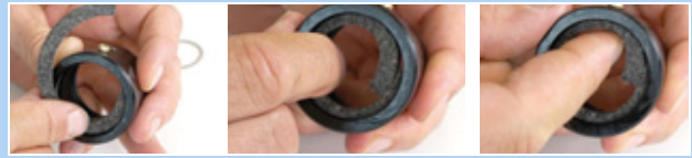
Rysunek 199: Wkładanie pierścienia filcowego
