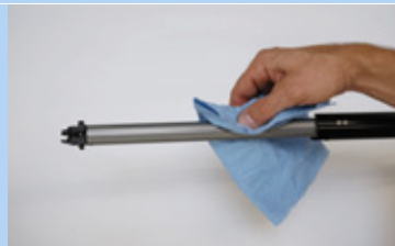
Rysunek 204: Czyszczenie podłużnego rowka prowadzącego
