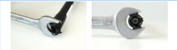
Rysunek 172: Zabezpieczenie przed przekręceniem się
