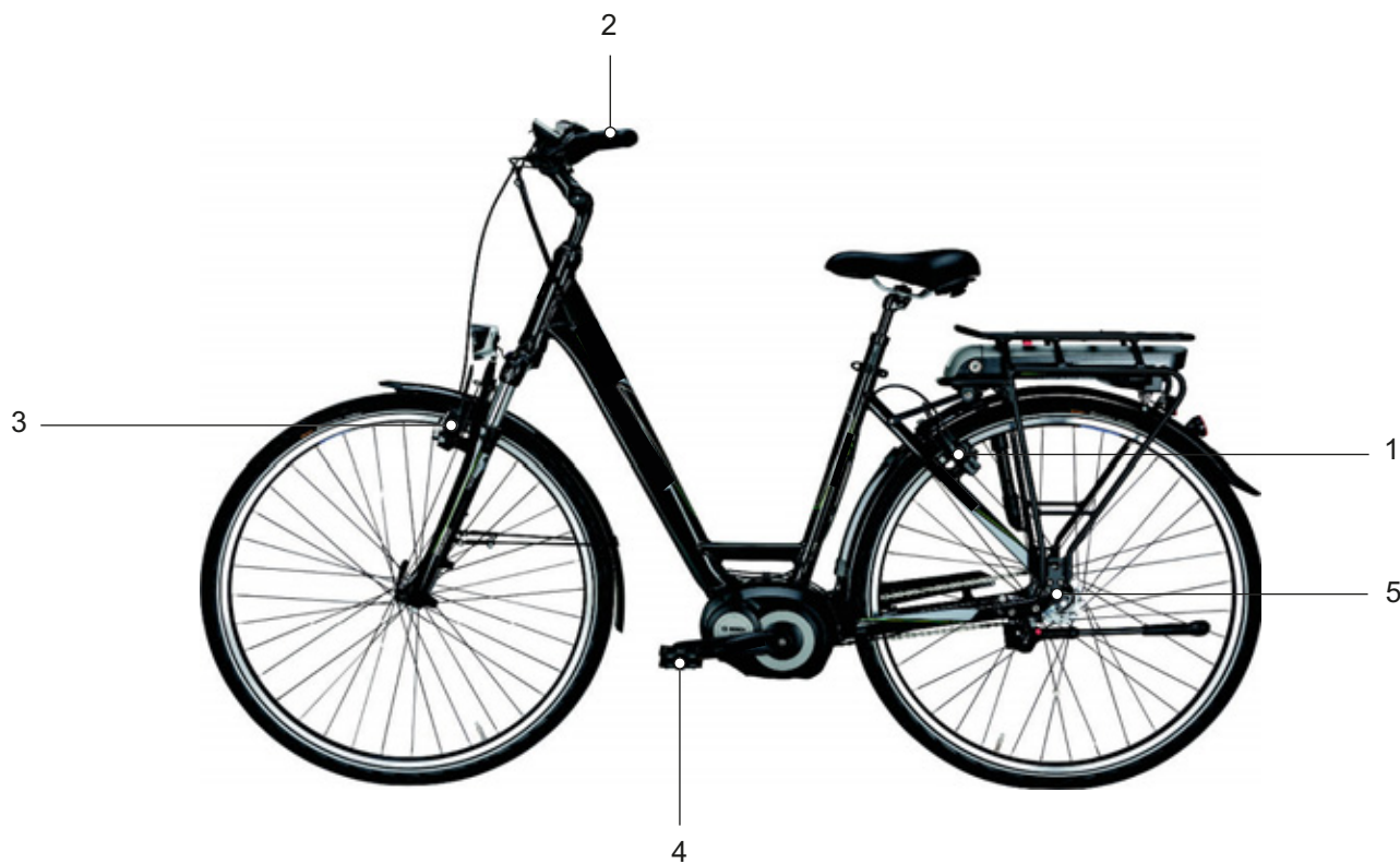
Rysunek 25: Układ hamulcowy wyposażony w hamulec nożny – przykład
