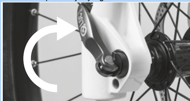
Rysunek 68: Zamykanie zacisku szybko mocującego
