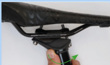
Rysunek 202: Otwieranie mechanizmu regulacji wysokości
