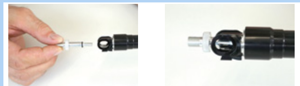
Rysunek 168: Wkręcanie adaptera zaworu
