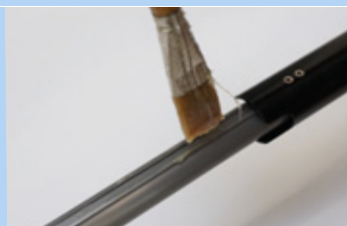
Rysunek 205: Nakładanie smaru
