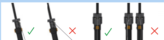
Rysunek 178: Prawidłowa i nieprawidłowa pozycja cięgna Bowdena
