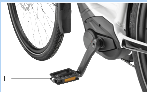
Rysunek 70: Pedał „L” w lewym ramieniu korby
