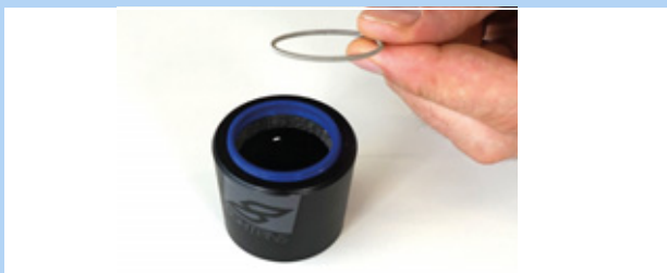
Rysunek 160: Wyciągnięty pierścień sprężysty
