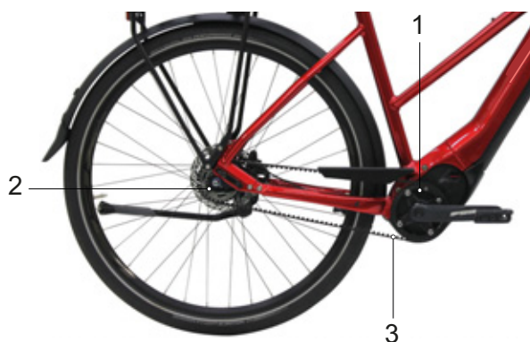
Rysunek 30: Schemat napędu paskowego
