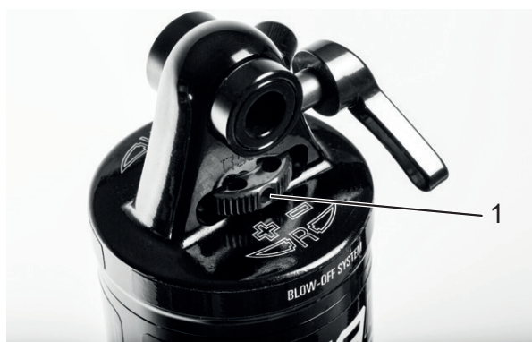
Abbildung 74: Suntour-Zugstufeneinsteller Rad (1) am Hinterbau-Dämpfer
