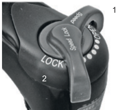
Abbildung 32: Suntour-Druckstufen-Einsteller mit den Positionen OPEN (1) und LOCK (2)
