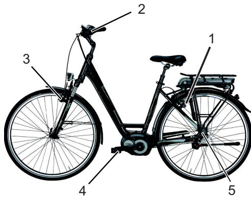
Abbildung 10: Bremssystem eines Pedelecs mit einer Rücktrittbremse, Beispiel
