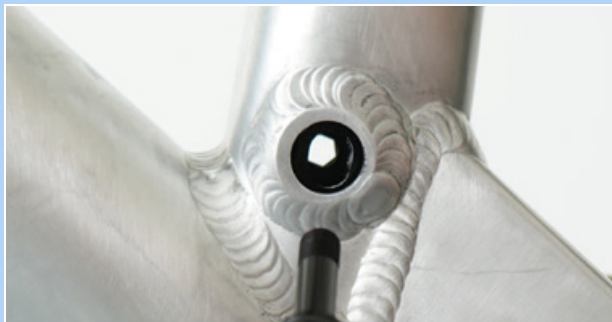
215. ábra: A Postpin csatlakozás nyílása
