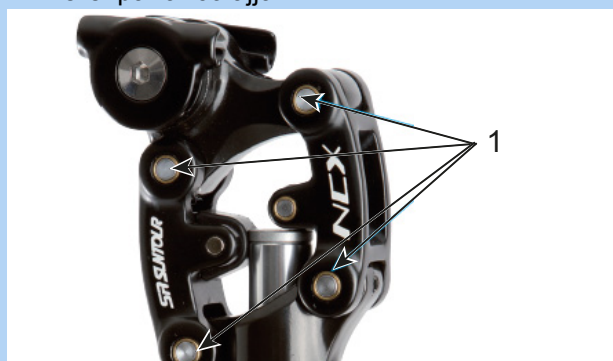
154. ábra: SR kenőpontok Suntour rugós nyeregcső
