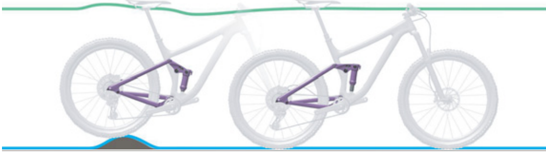
17. ábra: A hátsó lengéscsillapító optimális menetviselkedése egyenetlenségeknél
