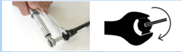
177. ábra: Beállítás az óramutató járásának irányában
