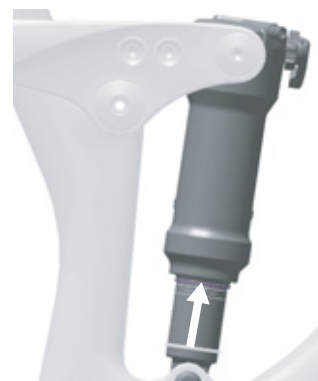
100. ábra: O-gyűrű eltolása a hátsó lengéscsillapítón
