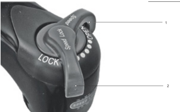
222. ábra: A nyomásfokozat-beállító keményebb beállítása
