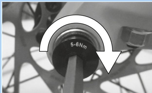
53. ábra: A rögzítőcsavar meghúzása
