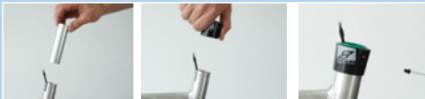
179. ábra: Siklópersely és külső hüvely beépítése
