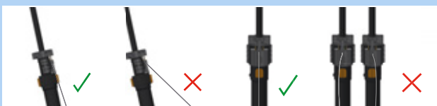
182. ábra: Helyesen és hibásan beállított bovdent
