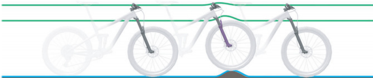
10. ábra: A villa optimális menetviselkedése egyenetlenségek esetén
