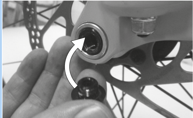
52. ábra: A gyorskioldó kar betolása a tengelybe
