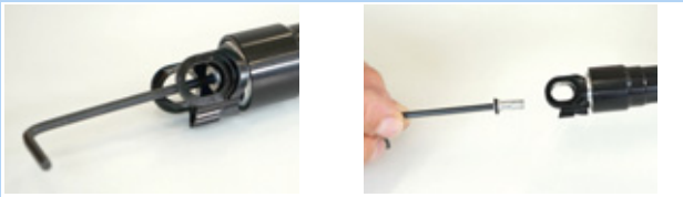
175. ábra: Szelepsapka kicsavarozása
