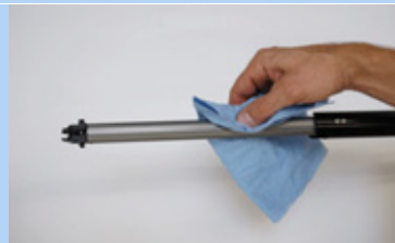
208. ábra: Hosszirányú vezetőhorny tisztítása
