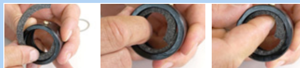
203. ábra: Filcgyűrű behelyezése
