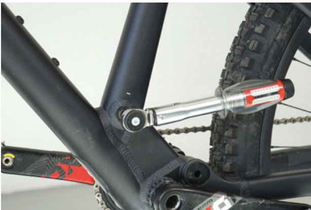
72. ábra: A nyeregcsőtengely meghúzása
