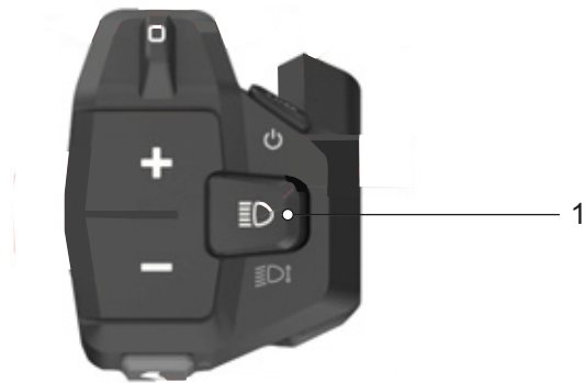
124. ábra: A világítás gomb elhelyezkedése
