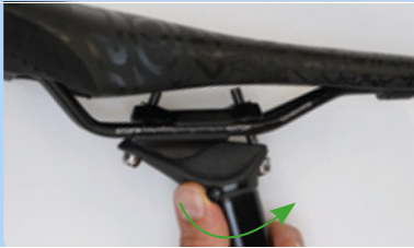
202. ábra: Magasságállítás nyitása
