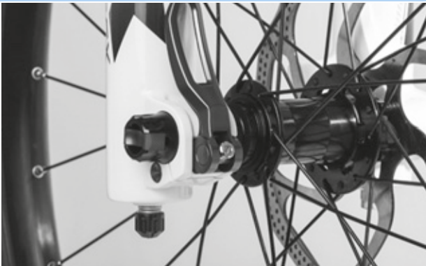
63. ábra: A gyorskioldó kar tökéletes helyzete
