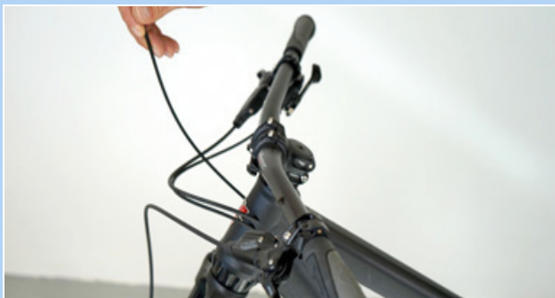
210. ábra: Végsapka beakasztása
