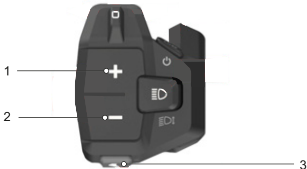
125. ábra: A plusz (1), mínusz (2) és tolási rásegítés (3) gombok elhelyezkedése
