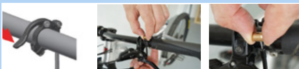
153. ábra: Tubus kiszérése
