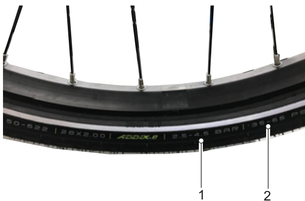
137. ábra: Guminyomás bar-ban (1) és psi-ben (2)
