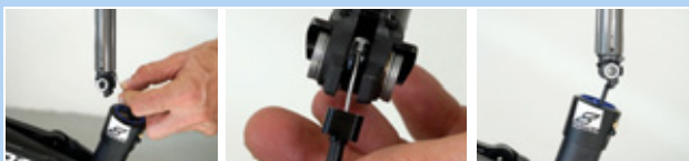
209. ábra: A nyeregcső felakasztása és betolása
