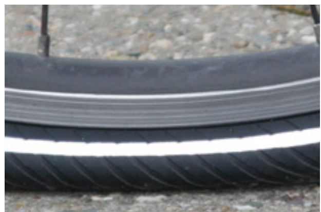
92. ábra: Túlontúl alacsony töltőnyomás
