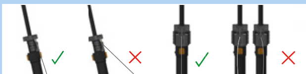
178. ábra: Helyesen és hibásan beállított bovdent
