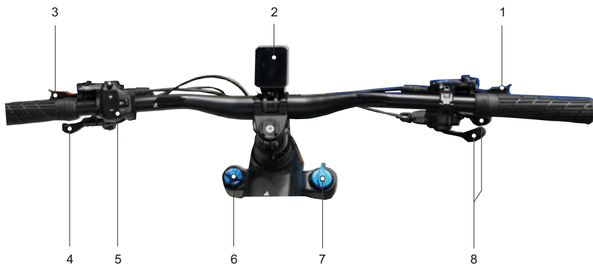
35. ábra: SHIMANO SC-E800 fedélzeti számítógéppel felszerelt kormány részletes nézete, példa
