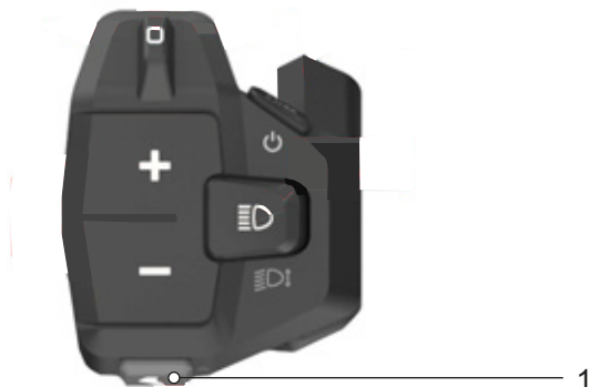
123. ábra: A tolási rásegítés gomb elhelyezkedése
