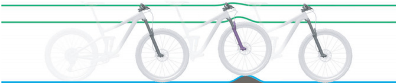
10. ábra: A villa optimális menetviselkedése egyenetlenségek esetén
