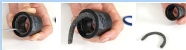
Obr. 177: Odstranění plstěného kroužku
