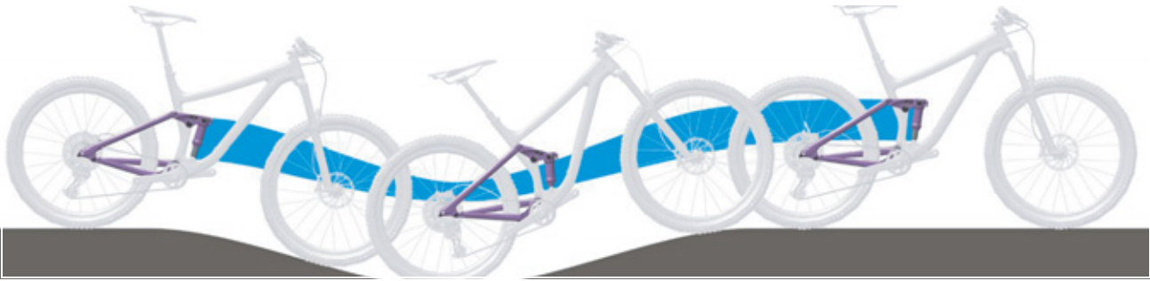
Obr. 240: Příliš měkké odpružení tlumiče zadního odpružení v horách
