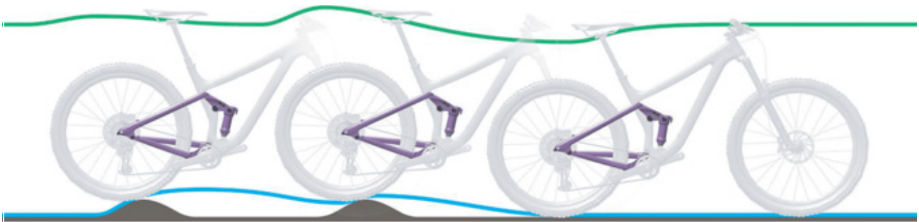
Obr. 238: Příliš pomalé roztahování tlumiče zadního odpružení
