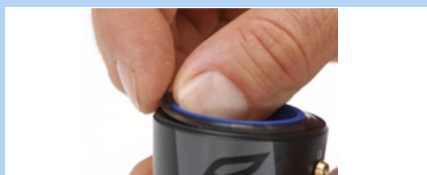
Obr. 209: Demontáž kroužek s těsnicími bříty
