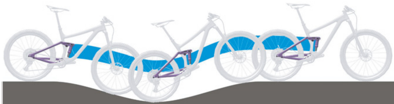
Obr. 17: Optimální chování tlumiče zadního odpružení při jízdě v kopcovitém terénu
