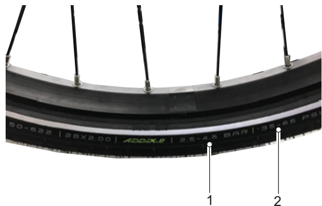
Obr. 152: Plnicí tlak v barech (1) a psi (2)
