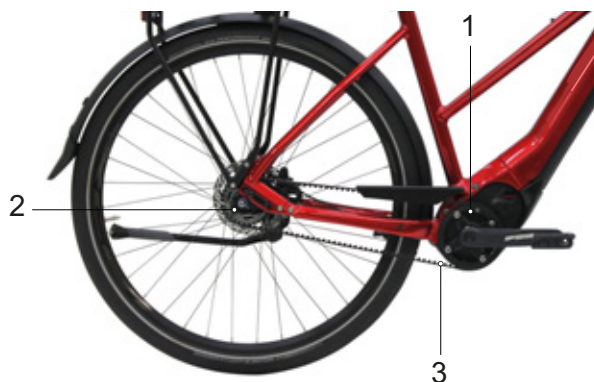
Obr. 34: Schéma řemenového pohonu
