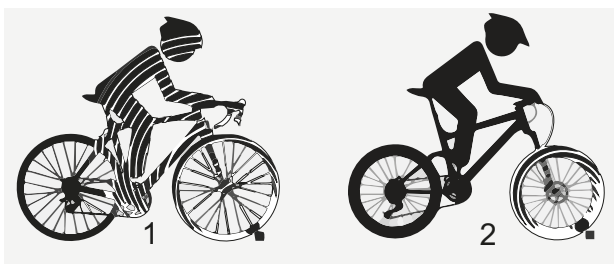
Obr. 7: Bez odpružení (1) a s odpružením (2)
