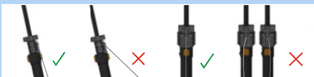
Obr. 193: Správné a nesprávné vedení bovdenů
