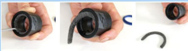
Obr. 212: Odstranění plstěného kroužku
