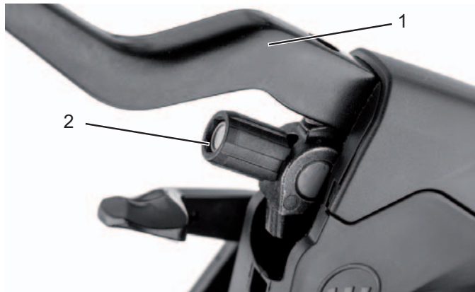
Illustration 28 : Levier de frein (1) du frein de jante à actionnement hydraulique avec vis de réglage (2)
