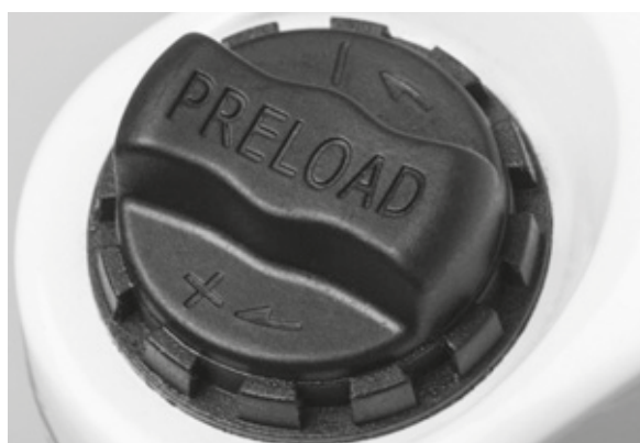
Illustration 40 : Molette de réglage du sag sur la couronne de la fourche de suspension
