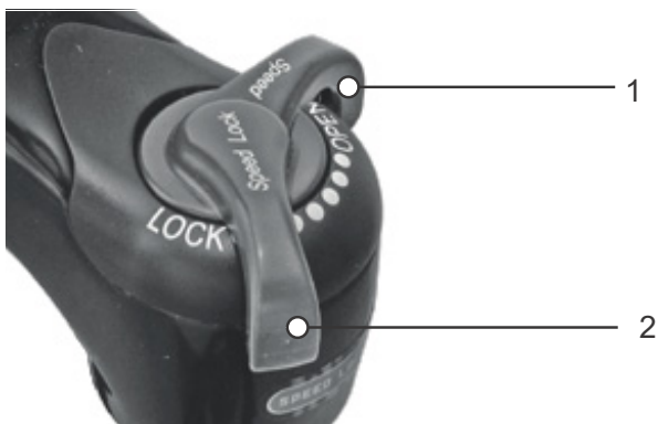
Illustration 75 : Amortisseur de compression Suntour en position ouverte (1) et fermée (2)
