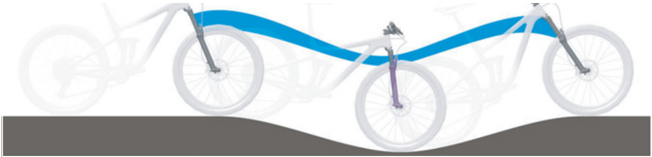
Illustration 74 : Suspension trop souple de la fourche de suspension dans les côtes
