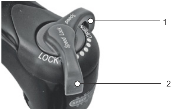
Illustration 77 : Amortisseur de compression Suntour en position ouverte (1) et fermée (2)
