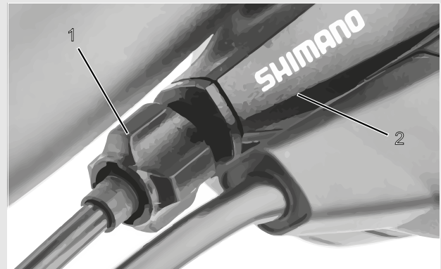
Rysunek 84: Nakrętka regulacyjna (1) jednocięgowego mechanizmu zmiany przerutek z obudową dźwigni zmiany biegów (2), przykład
