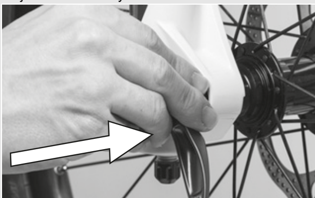
Rysunek 37: Wsuwanie zacisku szybko mocującego
