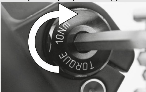
Rysunek 28: Sposób dokręcania włożonej osi
