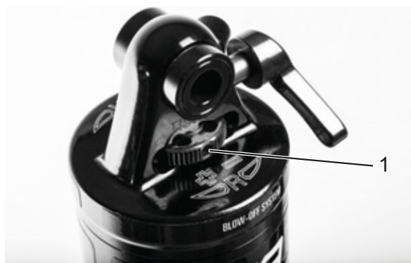
Rysunek 60: Nastawnik odbicia koła Suntour (1) na tylnym amortyzatorze
