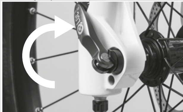
Rysunek 39: Zamykanie zacisku szybko mocującego
