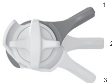
Rysunek 76: Nastawnik dobicia FOX obsługujący tylny amortyzator z pozycjami OTWARTE (1), ŚREDNIE (2) i TWARDE (3)
