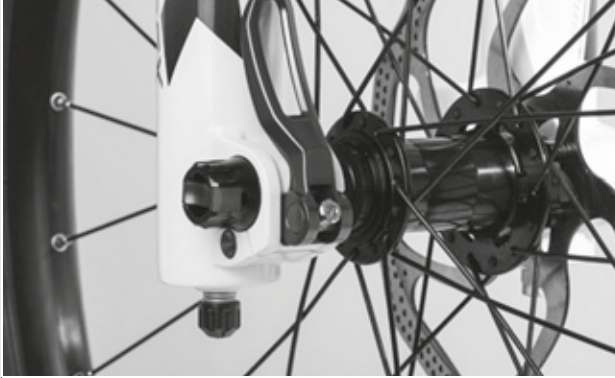
Rysunek 82: Ustawianie siły mocowania zacisku szybkomocującego
