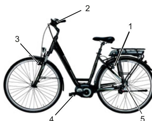
Rysunek 12: Układ hamulcowy roweru typu Pedelec z hamulec nożnym, przykład
