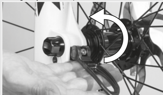
Rysunek 33: Sposób zabezpieczania dźwigni
