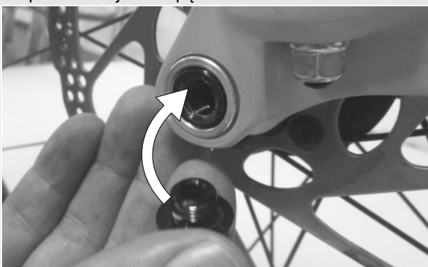
Rysunek 26: Sposób wsuwania dźwigni zacisku szybkoocucjącego w oś
