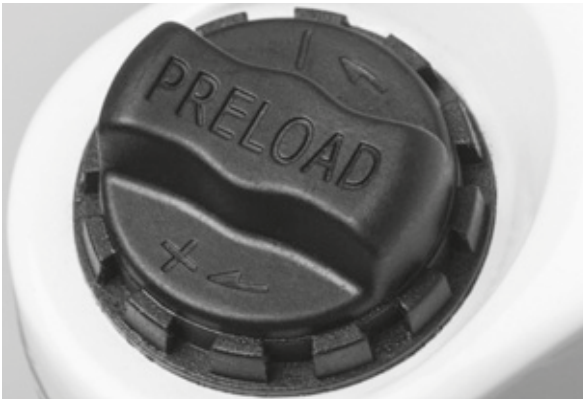
Rysunek 57: Pokrętko regulacyjne ujemnego skoku sprężyny, usytuowane na koronie widelca amortyzowanego
