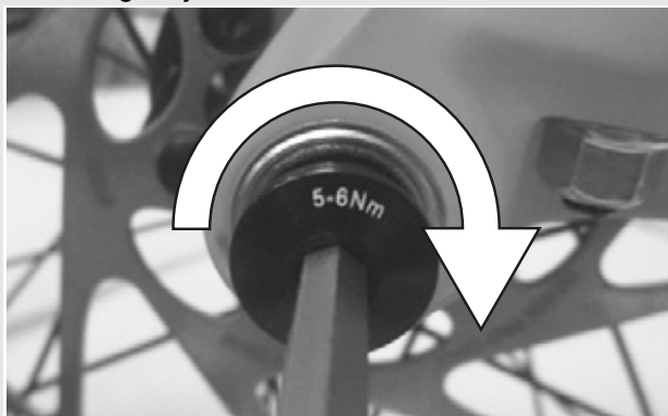
Rysunek 27: Sposób dokręcania śruby zabezpieczającej
