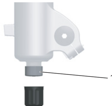
Rysunek 59: Nastawnik odbicia (1) FOX na widelcu
