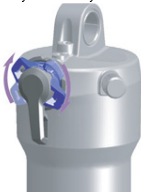
Rysunek 108: Ustawienie nastawnika dobiecia na twardszy tryb pracy
