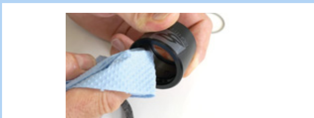
Rysunek 167: Czyszczenie tulei zewnętrznej
