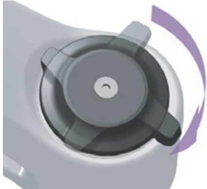
Rysunek 132: Ustawienie nastawnika dobiecia na twardszy tryb pracy
