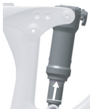
Rysunek 100: Przesuwanie pierścienia o-ring na tylnym amortyzatorze
