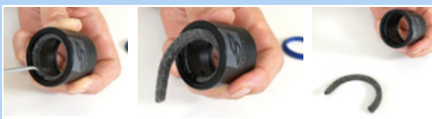
Rysunek 201: Wyciąganie pierścienia filcowego
