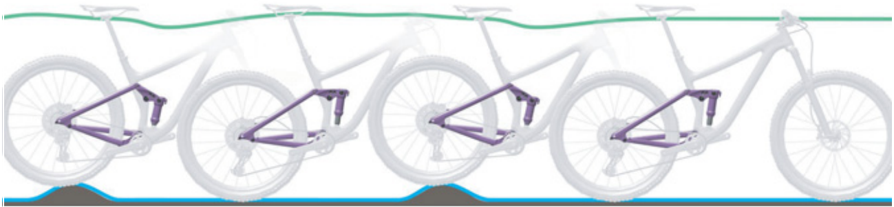
Rysunek 103: Optymalne działanie tylnego amortyzatora
