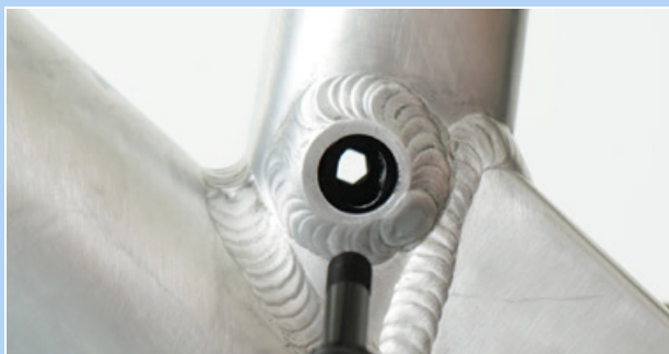
Rysunek 215: Otwór w miejscu styku sworznia
