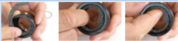
Rysunek 203: Wkładanie pierścienia filcowego
