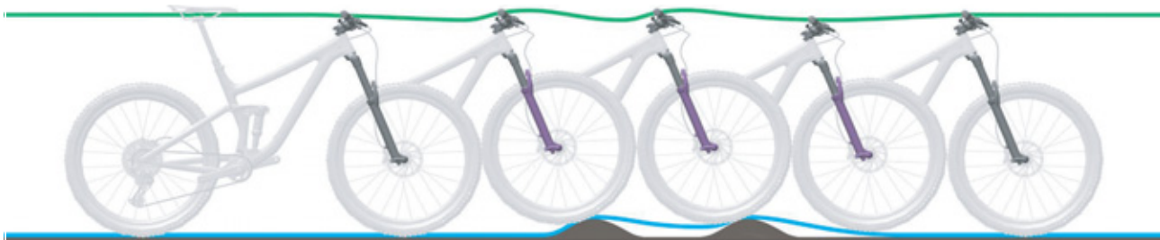
Rysunek 219: Zbyt wolne rozprężanie widelca amortyzowanego
