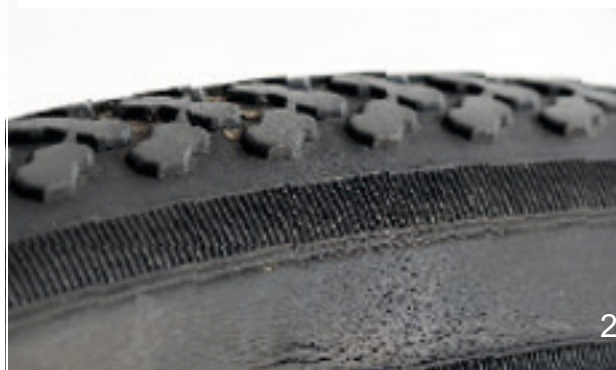
Rysunek 143: Przykłady pęknięć zmęczeniowych (1) i w wyniku starzenia się (2)
