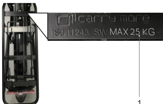
Rysunek 117: Na bagażniku umieszczona jest informacja o jego maksymalnej nośności (1)
