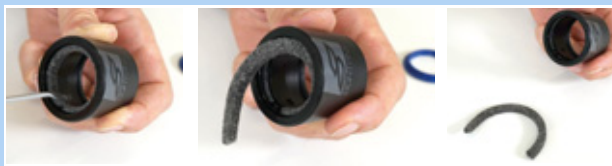
Rysunek 166: Wyciąganie pierścienia filcowego
