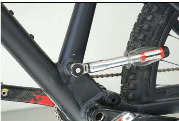
Rysunek 72: Dociąganie osi sztycy podsiodłowej
