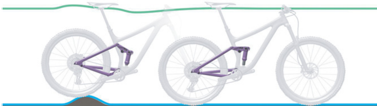
Rysunek 105: Optymalne działanie tylnego amortyzatora na nierównościach
