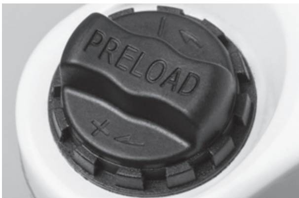
Figur 47: Indstillingshjulet til den negative fjedervandring på fjedergafflens krone
