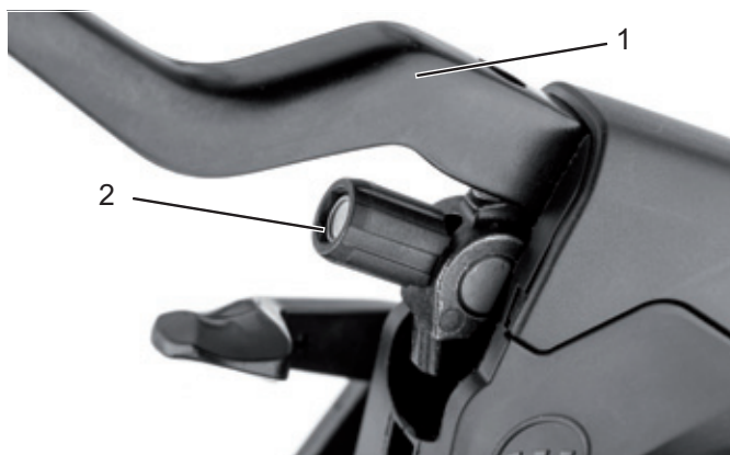
Figur 76: Bremsehåndtag (1) på den hydraulisk aktiverede fælgbremse med indstillingsskruen (2)
