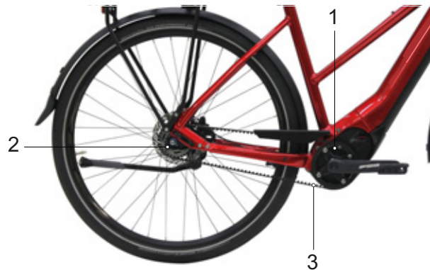
Figura 38: Schema della trasmissione a cinghia
