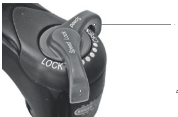
Figura 208: Regolazione più rigida del regolatore dello stadio di compressione
