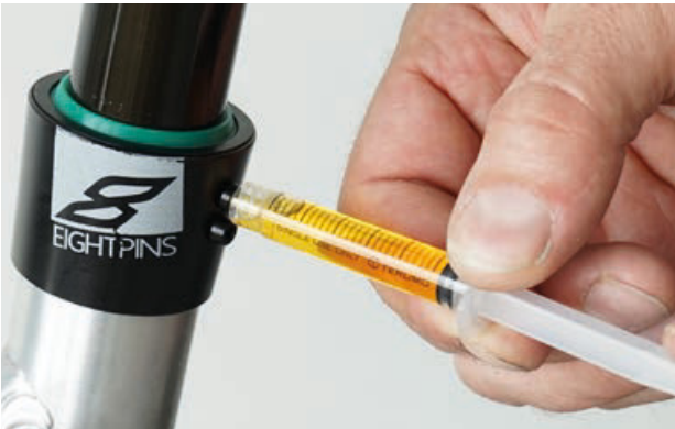
Figura 166: Lubrificazione del cannotto reggisella Eightpins
