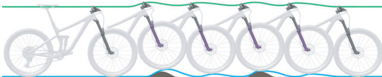
Figura 211: Corsa di estensione troppo veloce della forcella ammortizzata
