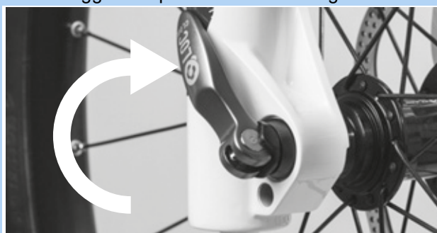
Figura 84: Chiusura del bloccaggio rapido
