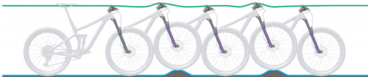
Figura 131: Comportamento di marcia ottimale della forcella
