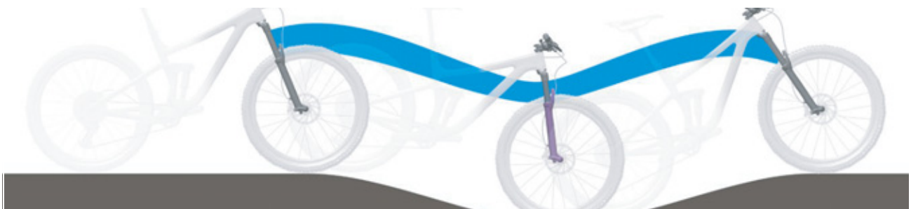
Figura 13: Comportamento di marcia ottimale su un terreno con dossi
