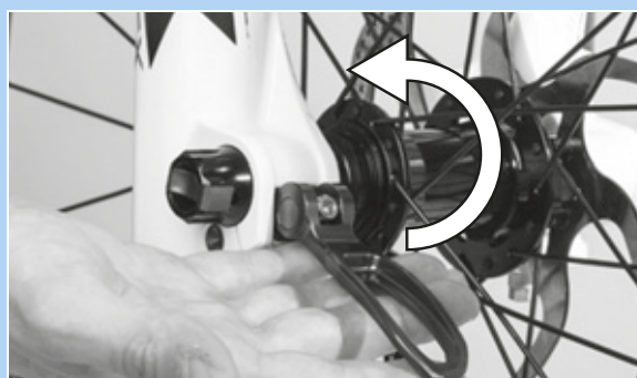
Figura 78: Spinta della leva del bloccaggio rapido nel verso della freccia
