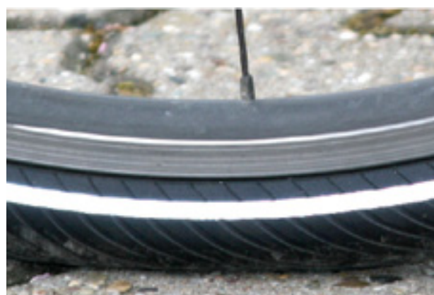
Figura 122: Corretta pressione di gonfiaggio. Lo pneumatico quasi non si deforma sotto il peso corporeo
