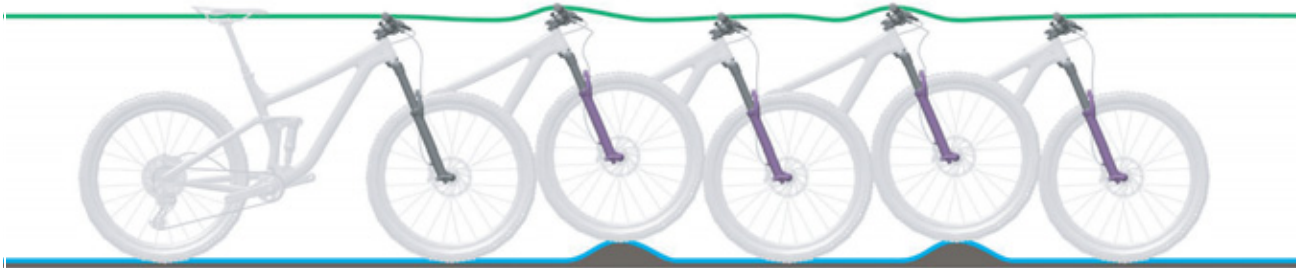
Figura 12: Comportamento di marcia ottimale della forcella
