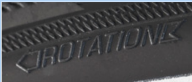
Figura 69: Freccia del senso di rotazione
