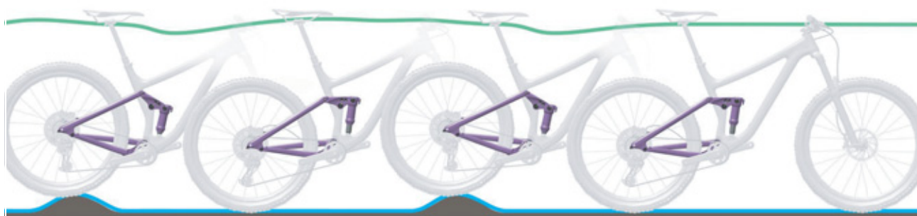
Figura 19: Comportamento di marcia ottimale dell'ammortizzatore del carro posteriore
