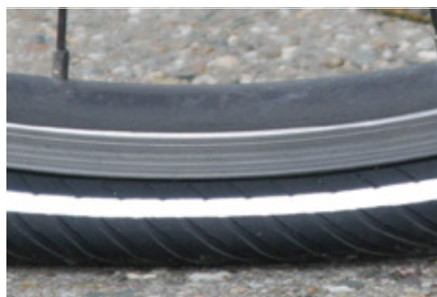
Figura 123: Pressione di gonfiaggio insufficiente
