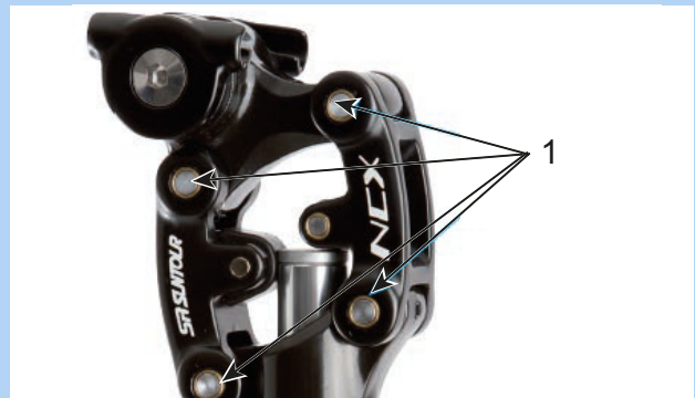
Figura 201: Punti di lubrificazione del canotto reggisella ammortizzato SR SUNTOUR
