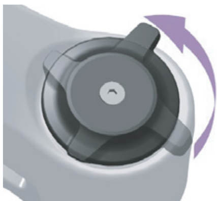
Figura 218: Regolazione più morbida del regolatore dello stadio di compressione
