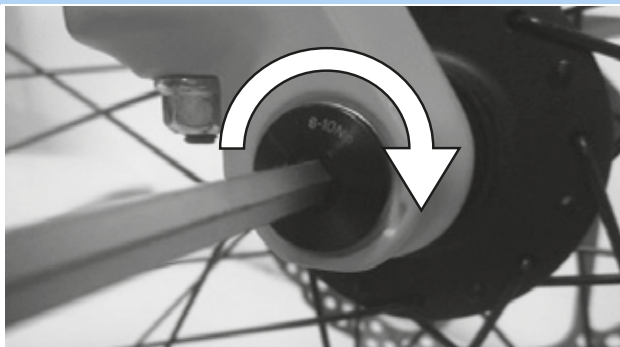
Figura 72: Serraggio del perno nel verso della freccia
