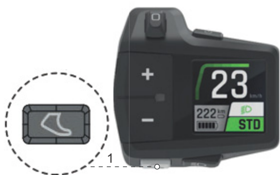
Figura 152: Ubicazione del tasto della funzione di assistenza di spinta
