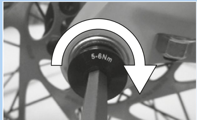
Figura 74: Serraggio della vite di sicurezza
