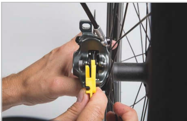
226. ábra: Fékbetét ellenőrzése beépített állapotban a szállítási rögzítés segítségével
