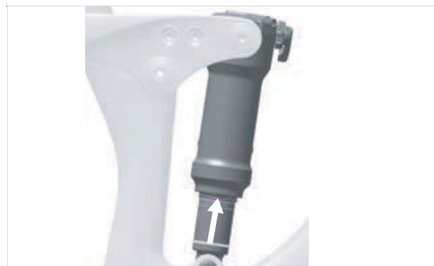
152. ábra: O-gyűrű eltolása a hátsó lengéscsillapítón
