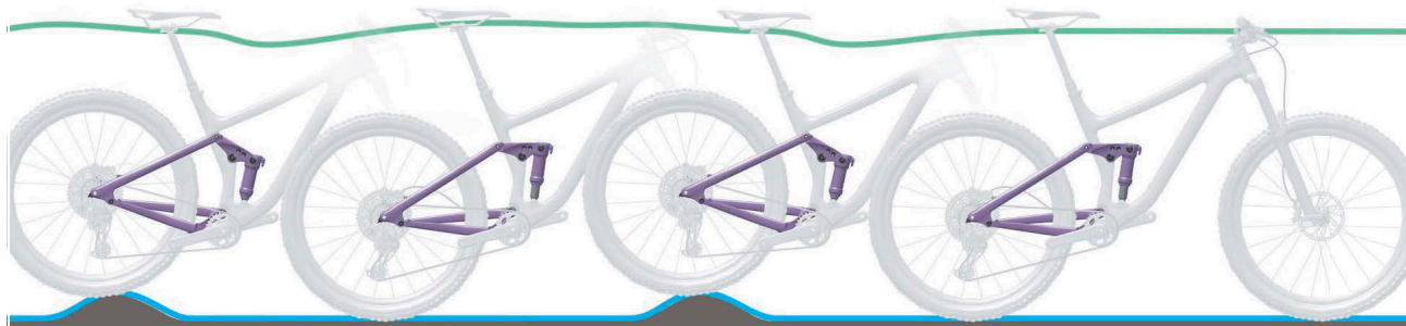
7. ábra: A hátsó lengéscsillapító optimális menetviselkedése
