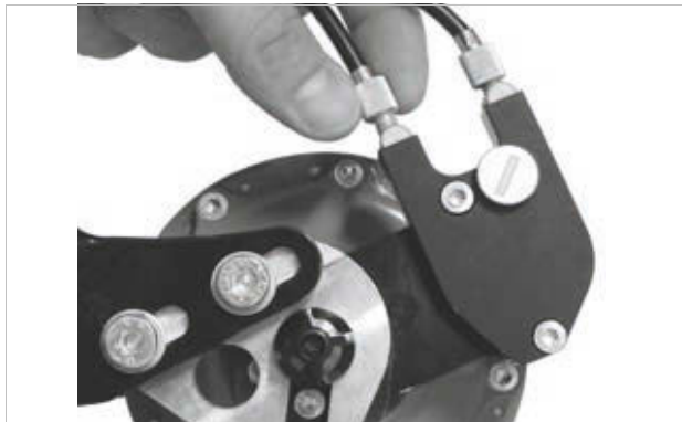
251. ábra: Külső váltóvezérléssel rendelkező ROHLOFF agyváltozatok húzásbeállítója a kötődobozon van, ami a bal oldalon található
