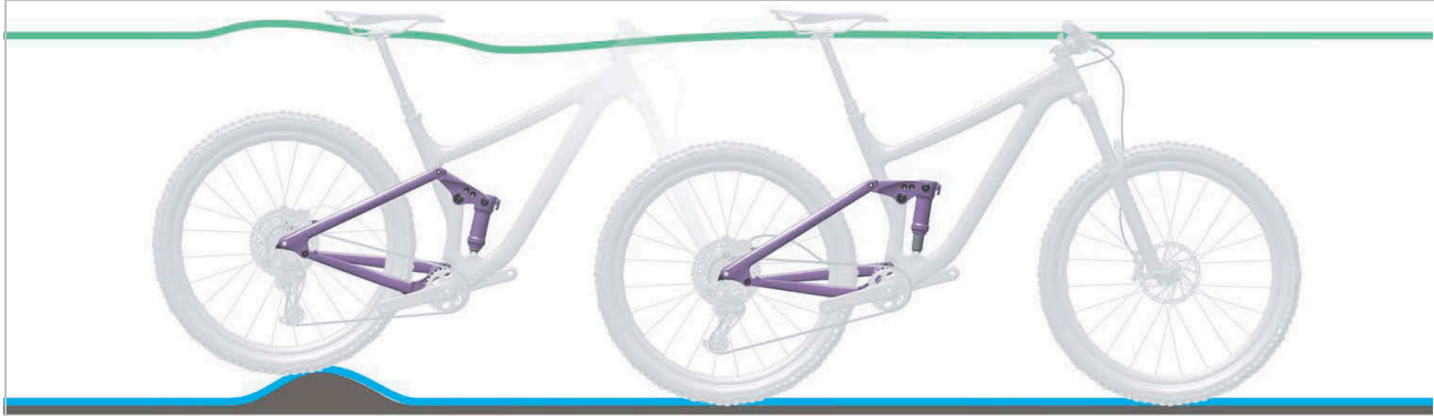
194. ábra: A hátsó lengéscsillapító optimális menetviselkedése egyenetlenségeknél
