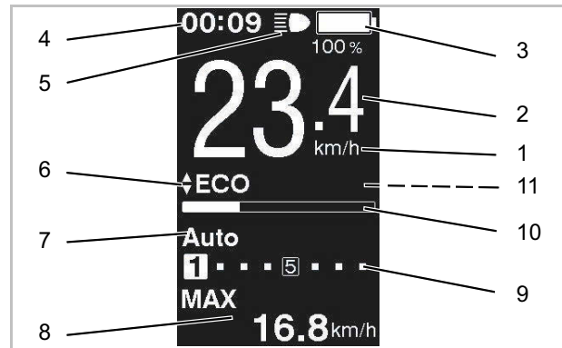
71. ábra: A kijelzőben látható kijelzések áttekintése
