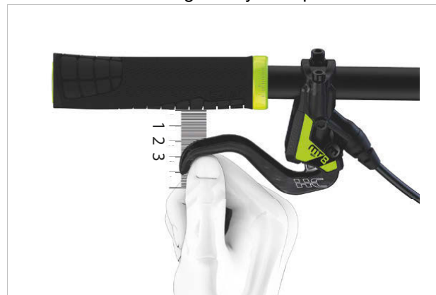
135. ábra: Kézifék pozicionálása
