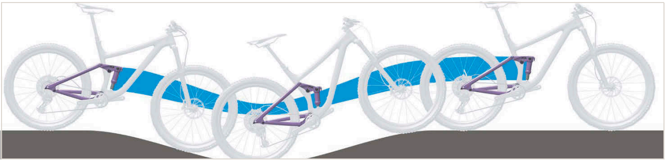
281. ábra: A hátsó lengéscsillapító túl puha rugózása hegymenetben
