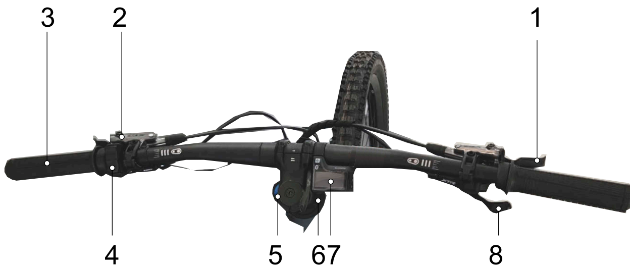
72. ábra: SHIMANO SC-E800 fedélzeti számítógéppel felszerelt kormány részletes nézete, példa
