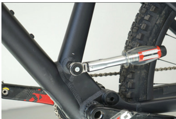
Figur 75: Fastspænding af sadelpindsaksel
