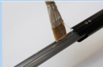
Figur 205: Påføring af fedt
