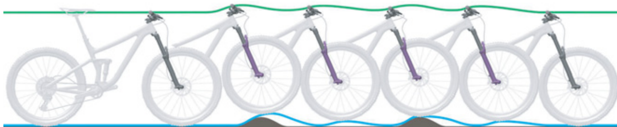
Figur 213: Fjedergaflen fjedrer for hurtigt tilbage
