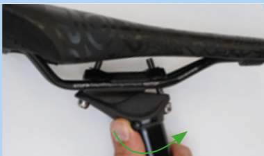
Figur 202: Åbning af højdeindstilling
