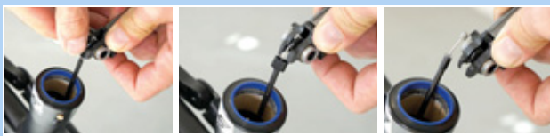
Figur 192: Fjernelse af bowdenkabel
