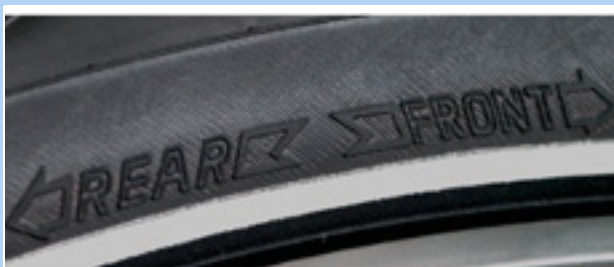
Figur 54: Køreretningspil på MTB-dæk
