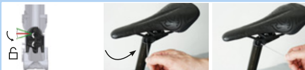
Figur 151: Sæt højdeindstillingsanordningen i "Åbnet stilling"
