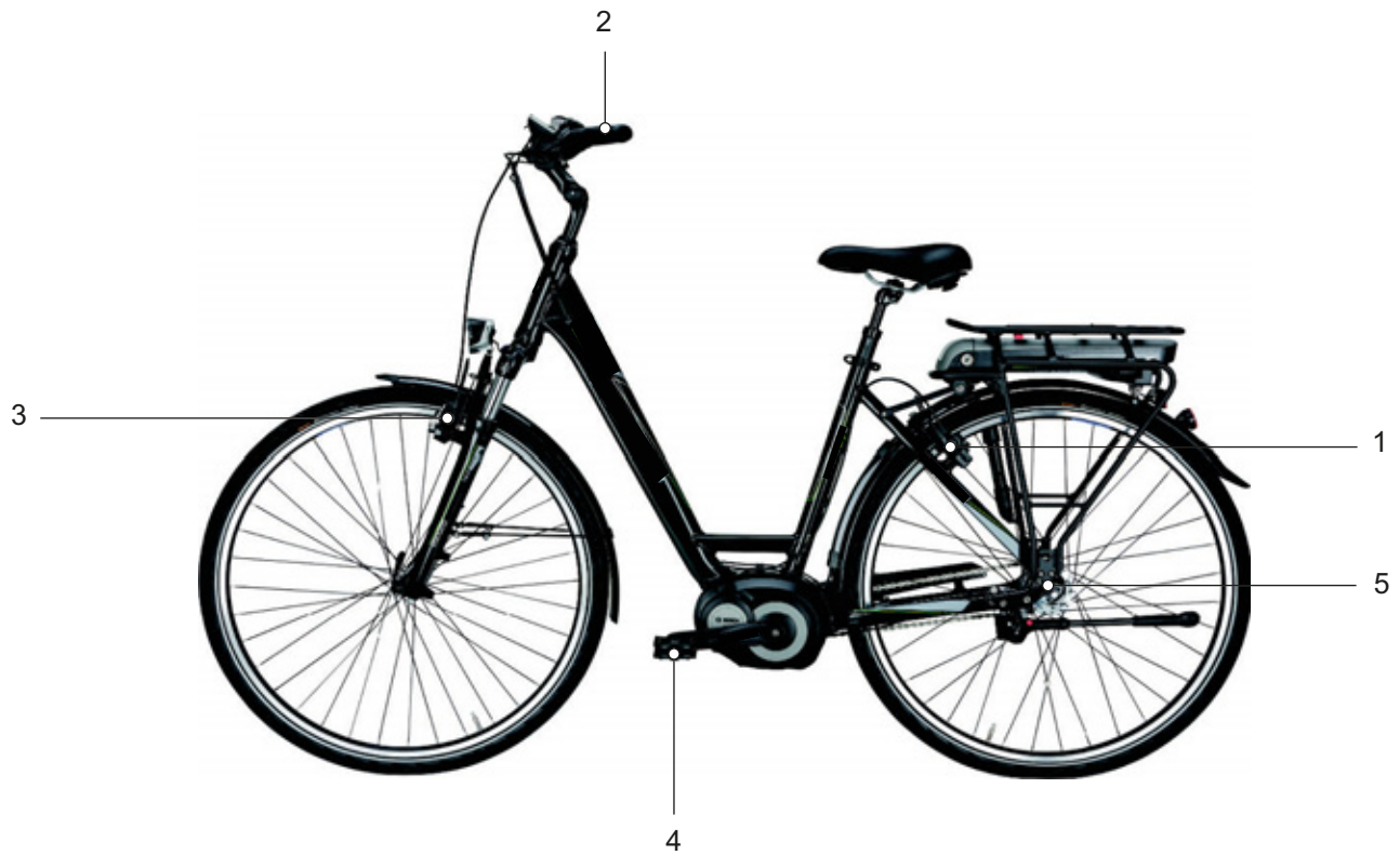
Figur 25: Bremsesystem med frihjulsbremse, eksempel
