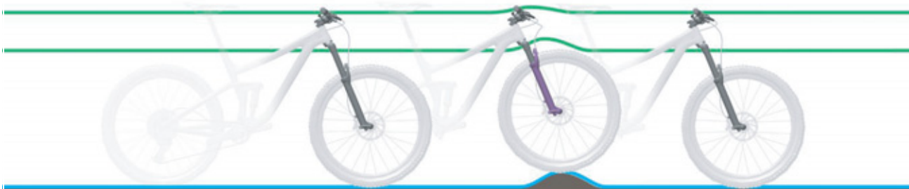
Figur 10: Gafflen kører optimalt ved ujævnheder
