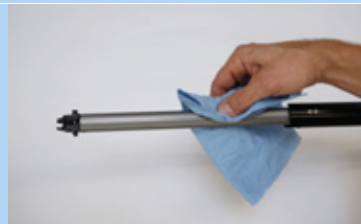
Figur 204: Rengøring af længdeføringsnot
