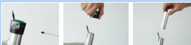
Figur 159: Afmontering af udvendig kappe og glidebøsning
