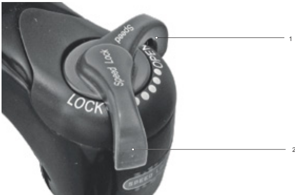
Figur 220: Blødere indstilling på tryktrins-indstillingsanordning
