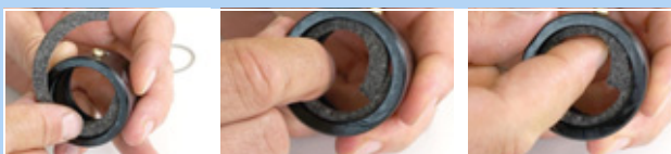
Figur 199: Ilægning af filtrering
