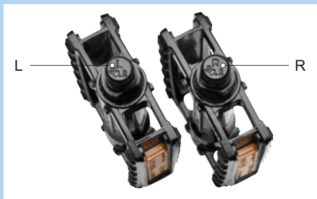
Figur 69: Eksempel på mærkning af pedaler
