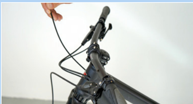
Figur 210: Fasthægtning af endekappe
