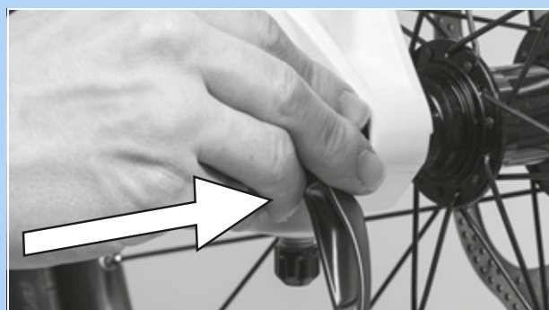
Figur 66: Skub hurtigbespændingen ind i pilens retning
